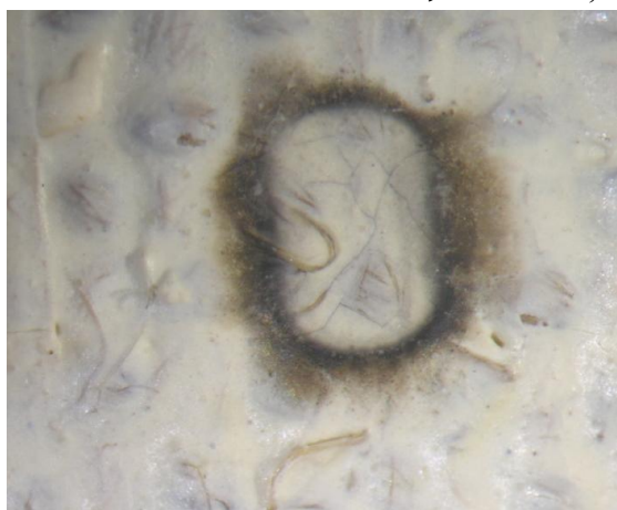
Figure 124 : élimination de la cêruse, \lambda : 193 nm, 1,7 J/cm 2 , 40 pulses, aucun effet
