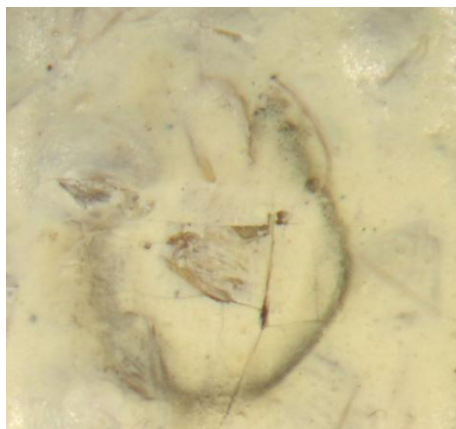
Figure 126 : élimination de la cêruse, \lambda : 248 nm, 1,12 J/cm².40 pulses, 500 fs, aucun effet
