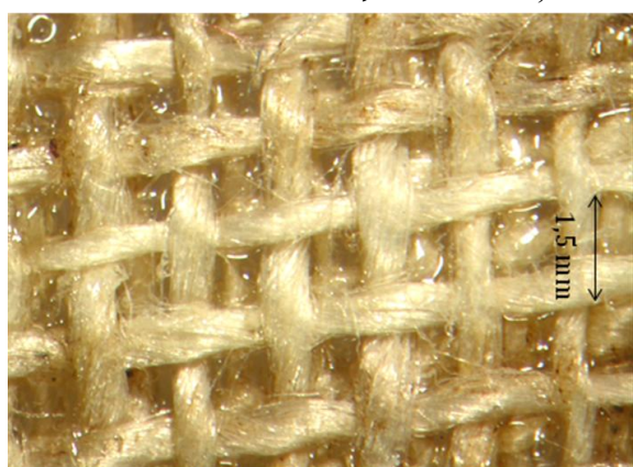
Figure 151 : élimination de la Mowilith® DMC2, \lambda : 532 \text{ nm} , F = 1,87 \text{ J/cm}^2 \cdot 5 \text{ pulses} , décoloration des fibres
