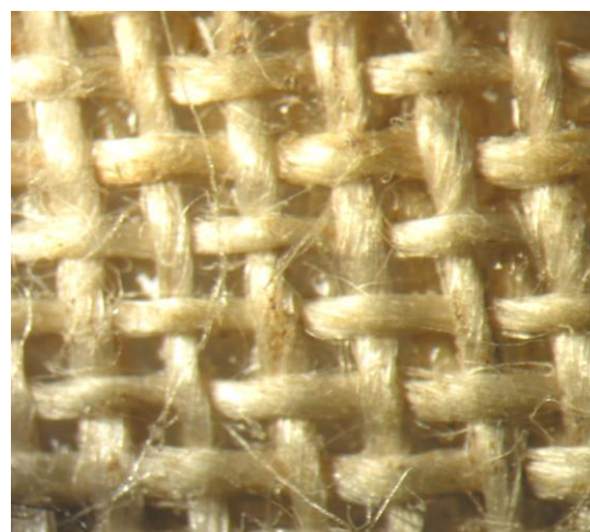
Figure 145 : élimination de la Mowilith® DMC2, \lambda : 193 nm, 2,5 J/cm 2 .40 pulses, Ablation +++
