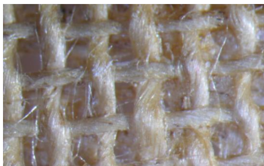
Figure 111 : élimination de la colle de pâte, \lambda : 193 nm, F : 1,7 J/cm 2 . 40 pulses, Ablation -
