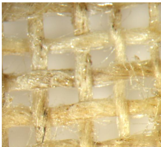
Figure 133 : élimination de la Beva®, \lambda : 193 nm, F = 1,7 J/cm 2 .10 pulses, Ablation +
