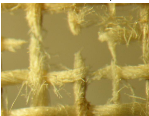
Figure 169 : élimination du Plexisol® P550, \lambda : 248 nm, F = 1,78 \text{ J/cm}^2 .40 pulses, fibres rompues
