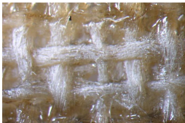
Figure 159 : élimination de la Mowilith® DM5, \lambda : 248 nm, F = 2,5 \text{ J/cm}^2 .40 pulses, Ablation +++
