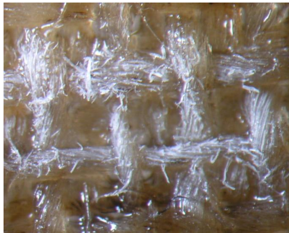
Figure 157 : élimination de la Mowilith® DM5, \lambda : 248 nm, F = 1,78 \text{ J/cm}^2 .10 pulses, Ablation +++
