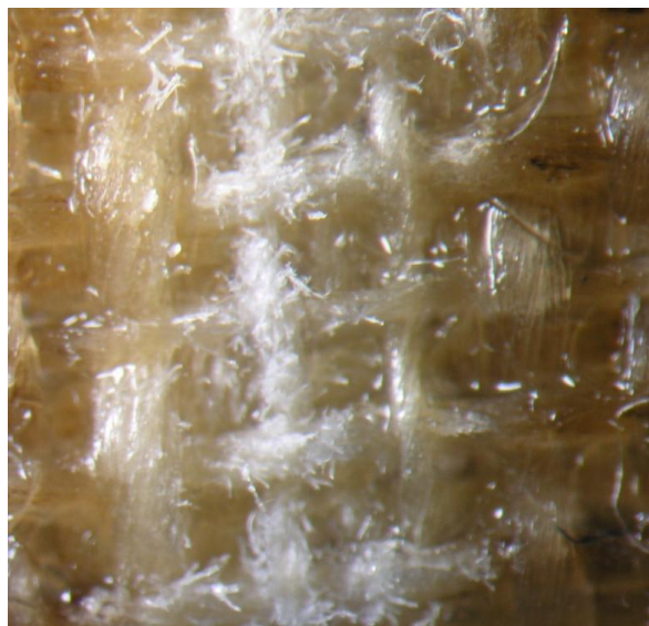
Figure 163 : élimination de la Mowilith® DM5, \lambda : 532 nm, F = 3,15 \text{ J/cm}^2 . 5 pulses, décoloration des fibres
