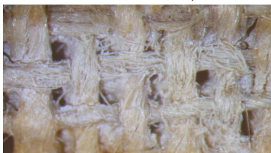
Figure 115 : élimination de la colle de pâte, \lambda : 248 nm, F = 1,78 J/cm 2 . 10 pulses, Ablation +++
