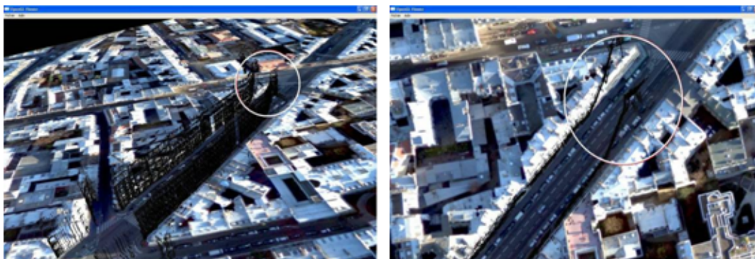
FIGURE 4.10 – Recalage rigide par changement de repère entre un nuage de points 3D et une photo aérienne sur la rue Gay Lussac à (Paris 5 ème ). Sur la fin du tronçon (partie encerclée), le résultat est aberrant et la déformation du modèle 3D est claire. Ceci est dû à une dérive de la centrale inertielle couplée à la perte des informations GPS. Une des solutions est la correction du modèle 3D en s'appuyant sur des techniques de recalage non rigide.
