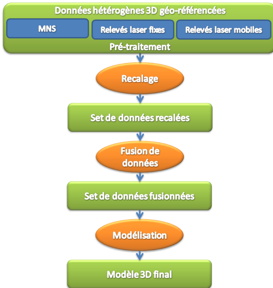
FIGURE 2.33 – Diagramme de traitement d'un processus de génération de modèles 3D à partir de données 3D hétérogènes. Malgré le géo-référencement une phase de recalage de données est requise pour garantir la qualité de la phase de fusion et de modélisation 3D.
