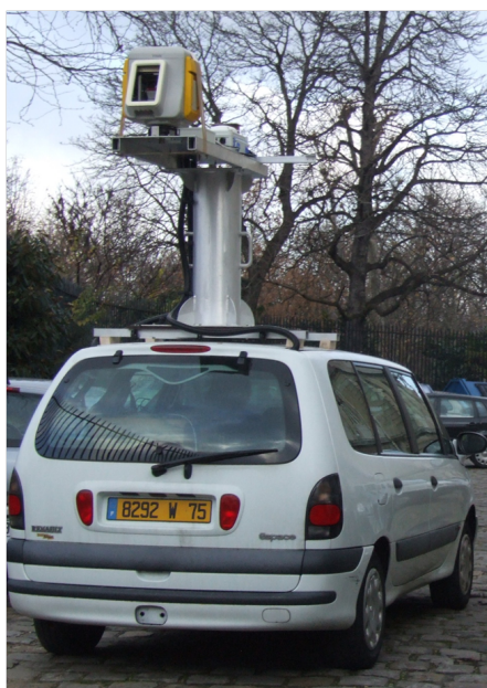
FIGURE F.2 – Montage du scanner laser 3D Trimble GX sur le véhicule Lara3D .
