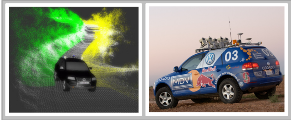
FIGURE 3.2 – Le système de cartographie mobile Stanley , vainqueur de l'édition 2005 de DARPA challenge (Source des illustrations : http://cs.stanford.edu/ ).
