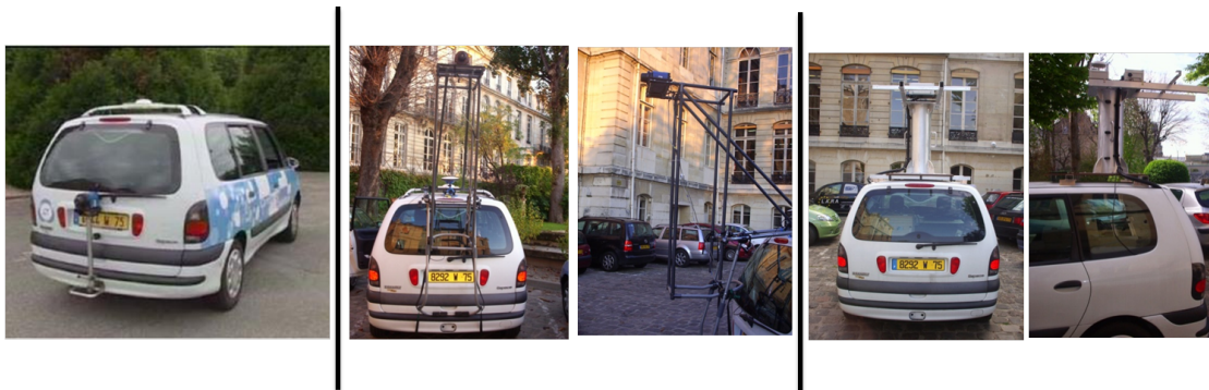
FIGURE 4.19 – Lara3D : (à gauche) V1 avec télémètre à H = 0.6m . (au centre) V2 expérimentale avec télémètre à H = 3.1m . (à droite) Version actuelle avec validation du prototype expérimental de la V2.
