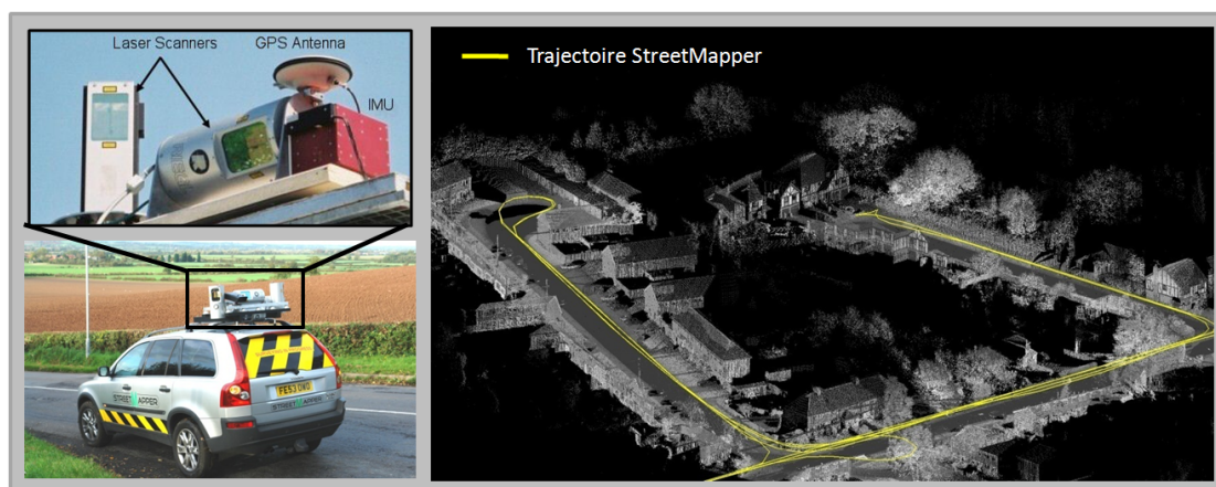
FIGURE 2.23 – (à gauche) Système de cartographie mobile à base de télémétrie laser ( StreetMapper ). (à droite) Résultat de l'acquisition du village de Halstead aux États-Unis (Source des illustrations : http://www.3dlasermapping.com ).
