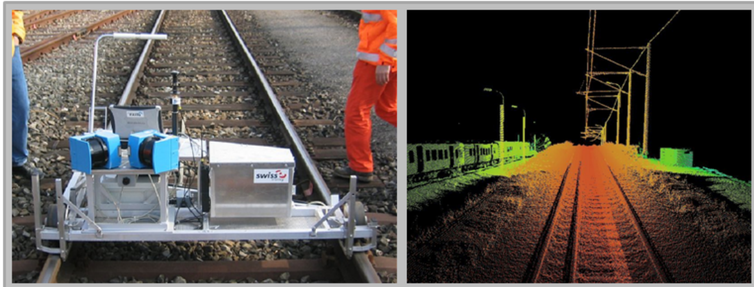
FIGURE 3.5 – (à gauche) Système de cartographie mobile monté sur un chariot Swiss trolley . (à droite) Résultat de la numérisation 3D (Source des illustrations : http://www.terra.ch/ ).
