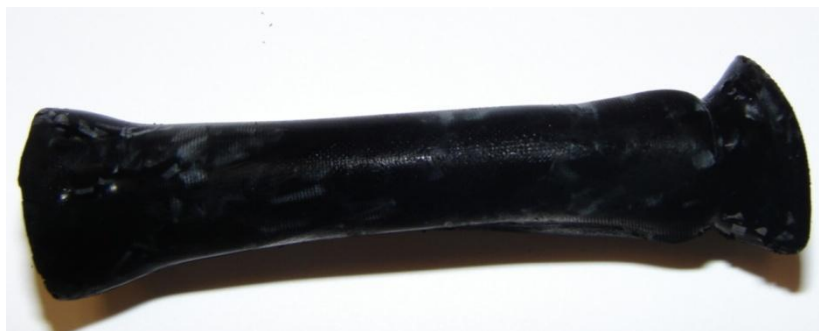
Figure 26: Aérogel de carbone obtenu après pyrolyse
