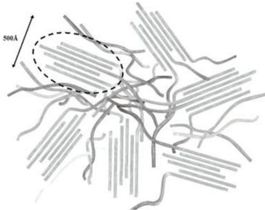
Figure 61: Schématisation de la membrane nafion ® sous la forme de paquets de tiges, la position et l'orientation de ces paquets de tiges est variable, leur taille est évaluée à 50- 100 nm en fonction de la teneur en eau [217]
