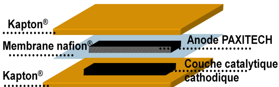
Figure 30: Assemblage pour la première étape de pressage
