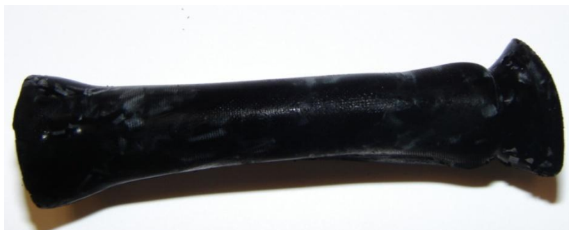
Figure 26: Aérogel de carbone obtenu après pyrolyse
