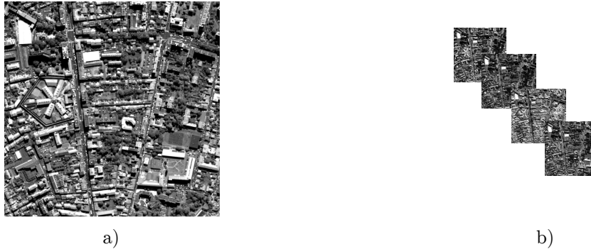
Figure 1.1 : Illustration des images intervenant dans la fusion. (a) Image PAN, résolution 0.7 m. (b) Images MS résolution 2.8 m. Copyright CNES 2000.
