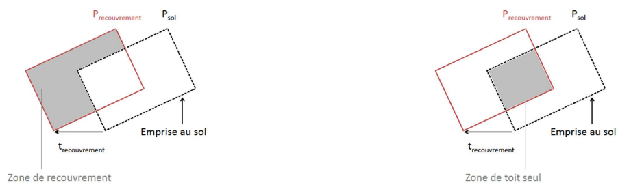
(a) Génération de la "zone de recouvrement" pour la configuration 1 (b) Génération de la "zone de toit seul" pour la configuration 1
