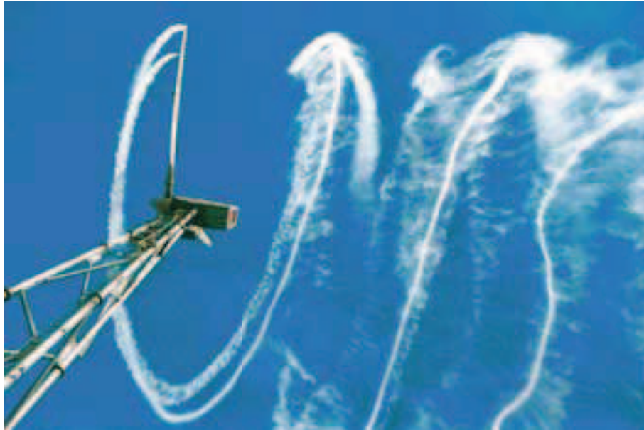
FIGURE 2.3: Structure du sillage en aval d'une éolienne, révélée par la fumée [Risoe, 1997]
