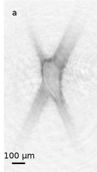
Figure 3.1 Image in situ d'un nuage froid piégé dans un potentiel optique croisé. Le nuage d'atomes de rubidium est visible au centre. Les bras du piège apparaissent car certains atomes un peu plus chauds explorent des régions périphériques du piège. Extrait de [Brantut 2008].
