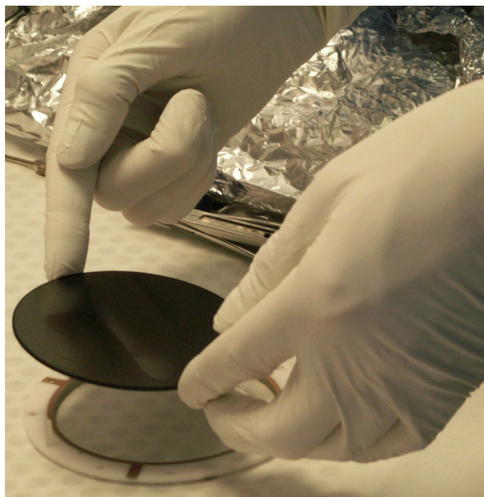
Figure A.4 Photographie d'une galette à micro-canaux prise lors de son montage. Deux galettes sont posées l'une sur l'autre pour accroître l'amplification. Nous les mettons en sandwich entre deux anneaux de céramiques sur lesquels sont déposés une couche de cuivre. Nous pouvons ainsi appliquer un potentiel électrique au face avant et arrière de ces galettes.
