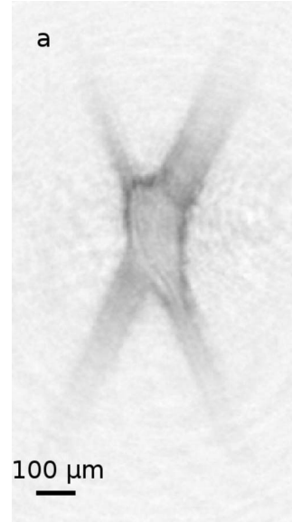
Figure 3.1 Image in situ d'un nuage froid piégé dans un potentiel optique croisé. Le nuage d'atomes de rubidium est visible au centre. Les bras du piège apparaissent car certains atomes un peu plus chauds explorent des régions périphériques du piège. Extrait de [Brantut 2008].
