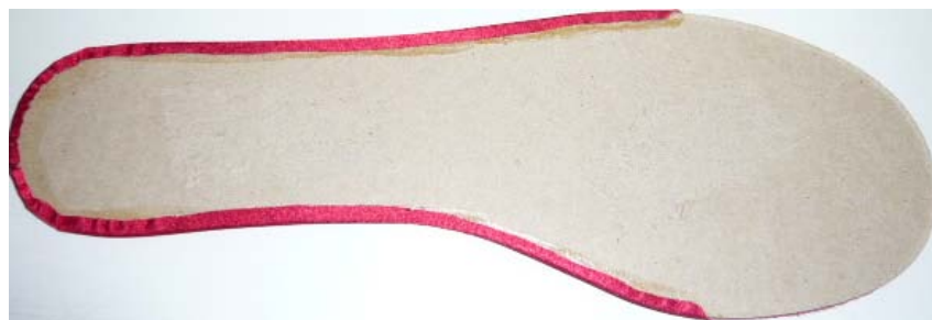
Figure 54. Première carton enrobée
