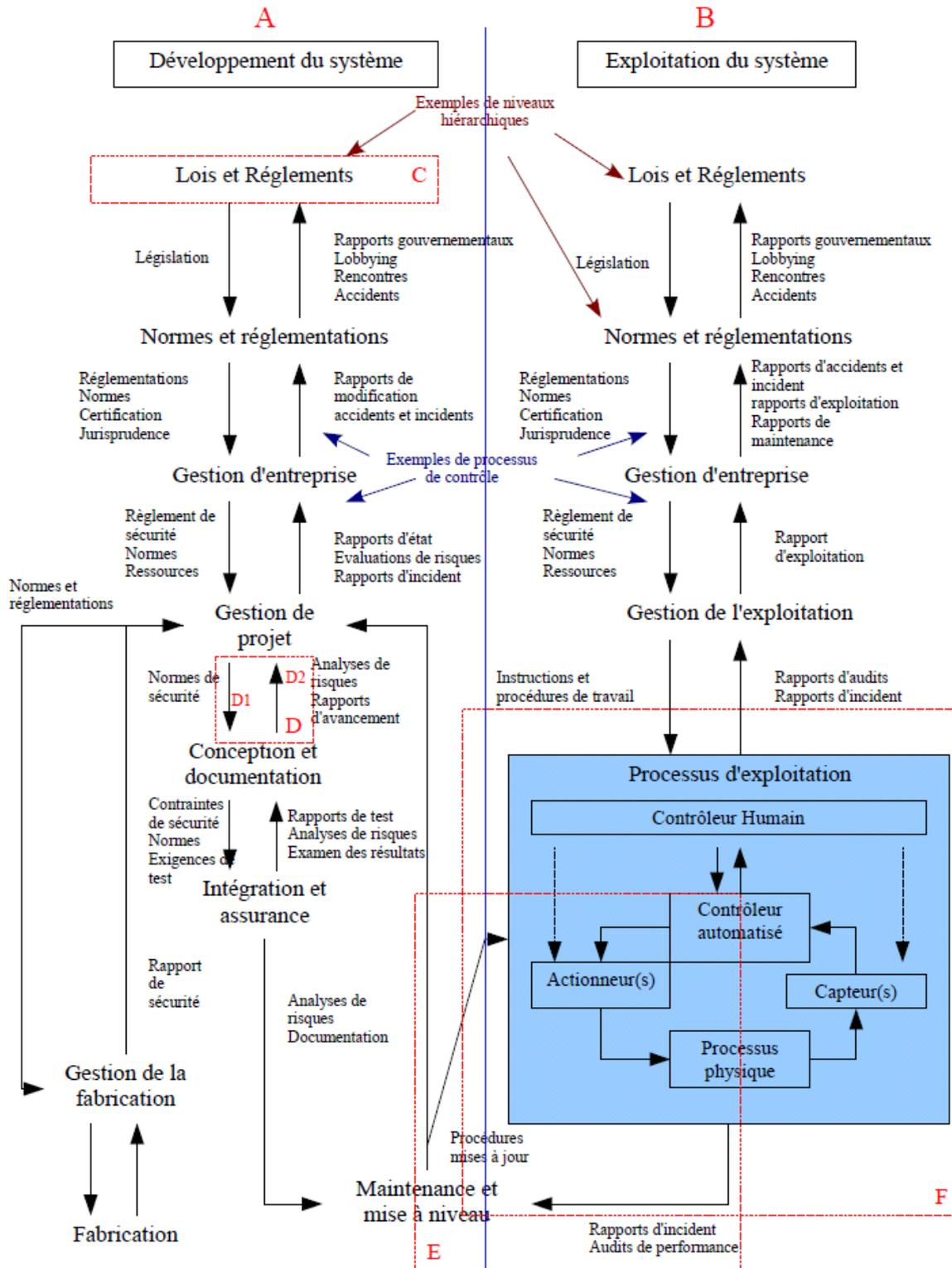
Figure 12 ■ Représentation générale d'une structure de contrôle socio-technique adaptée de Leveson [Leveson, 2005]
