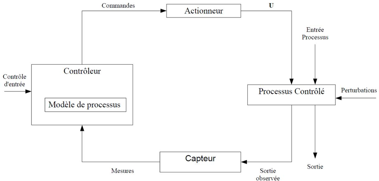
**Figure 13 ■ Boucle de contrôle de processus**
