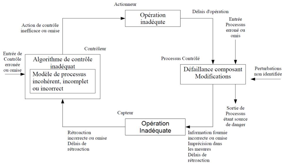
**Figure 32 ■ Boucle de contrôle inadéquat**
