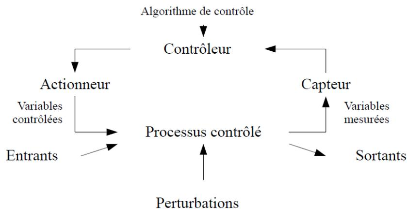
Figure 10 ■ Boucle de contrôle standard
