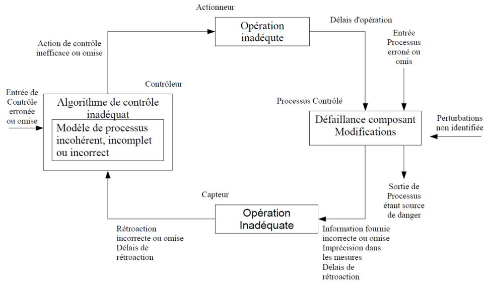
**Figure 17 ■ Boucle de contrôles inadéquats**
