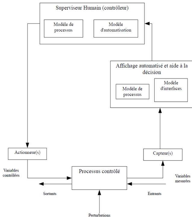
**Figure ■15 ■ Processus contrôlé par opérateur humain avec une assistance automatisée**
