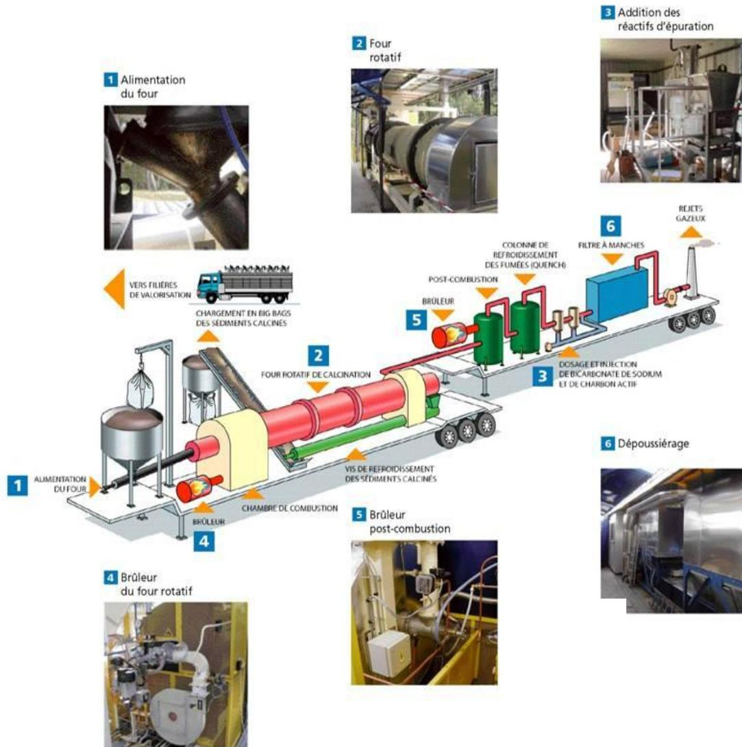
Figure 24 ■ Étape de calcination du procédé Novosol®
