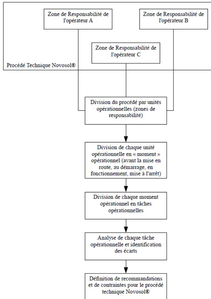
Figure 29 ■ Démarche HAZOP pour le procédé technique Novosol®
