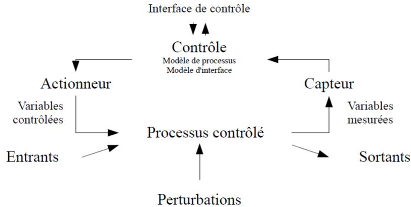
**Figure 11 ■ Boucle de contrôle supervisée**
