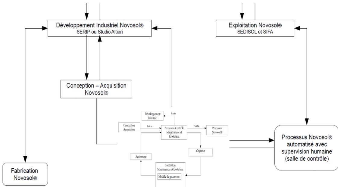
**Figure 34 ■ Description d'une boucle de contrôle au sein de la structure de contrôle du système Novosol®**
