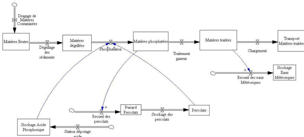
Figure 25 ■ Modèle dynamique de la phase de phosphatation du système technique Novosol®
