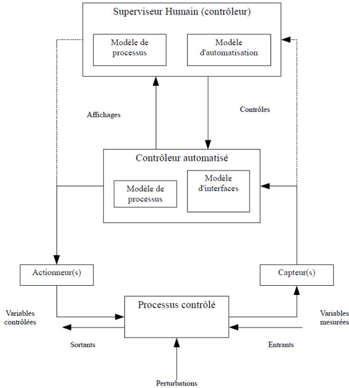
**Figure 14 ■ Processus automatisé mais supervisé par un contrôleur humain**
