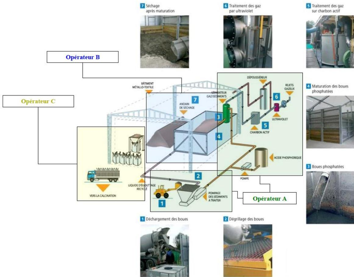
**Figure 23 ■ Étape de phosphatation du procédé Novosol<sup>®</sup> illustrée en fonction des zones de responsabilité de chaque opérateur**
