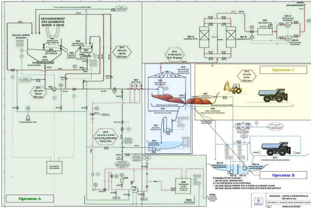
Figure 22 ■ Diagramme de flux Novosol<sup>®</sup> lors de la phase de phosphatation organisé en fonction des zones de responsabilité de chaque opérateur
