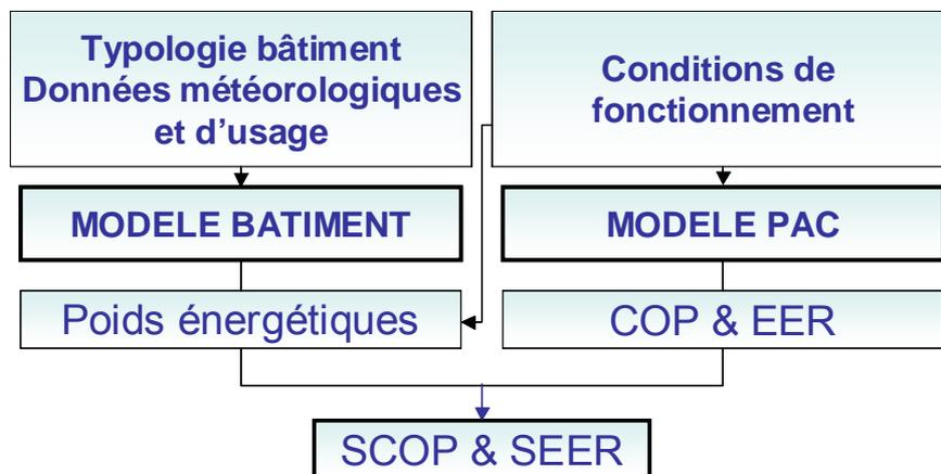
Figure 4-1 : Couplage modèle bâtiment et modèle de pompe à chaleur
