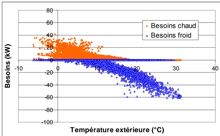
Figure 4-10 : Courbe de charge d'un bâtiment neuf à Mâcon (avec un ralenti de nuit)
