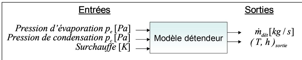
Figure 2-17 : Algorithme de calcul du détendeur thermostatique
