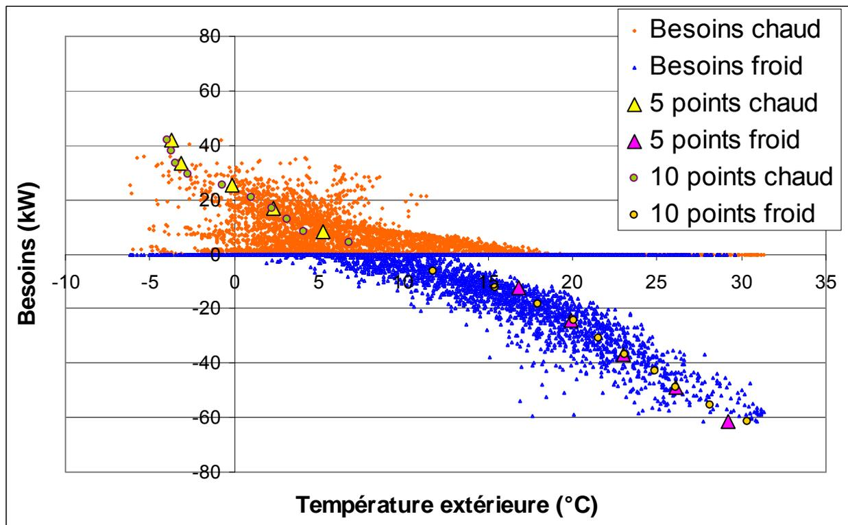
Figure 4-16 : Réduction de la courbe de charge de 8760 points à 5 et 10 points par mode de fonctionnement pour le bâtiment de référence neuf à Mâcon
