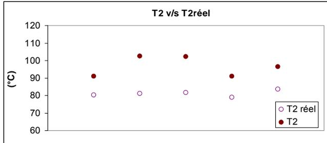
Figure 3-43 : Comparaison des températures à la sortie de compresseur (T<sub>2</sub>réel) réelles et calculées par le modèle de simulation (T<sub>2</sub>)
