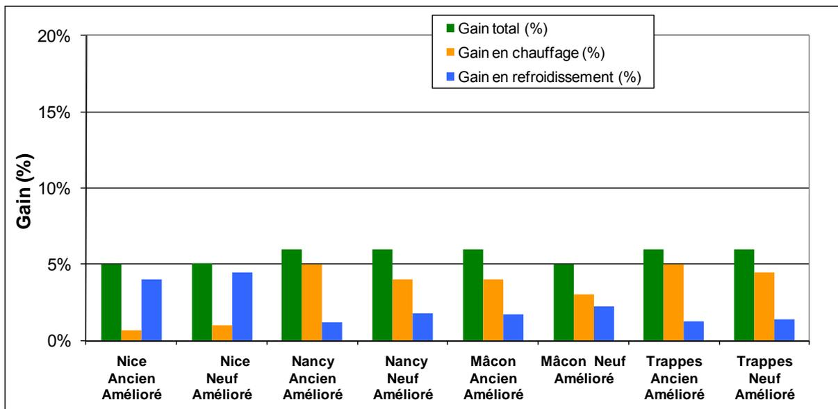
Figure 5-7 : Comparisons des consommations électriques annuelles de l'option d'amélioration (ventilateur à vitesse variable) par rapport à la machine de référence
