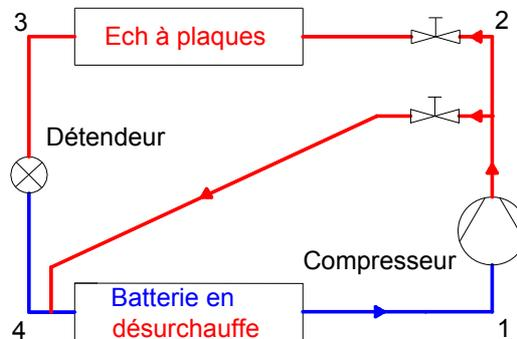
Figure 3-6 : Mode dégivrage par injection gaz chaud
