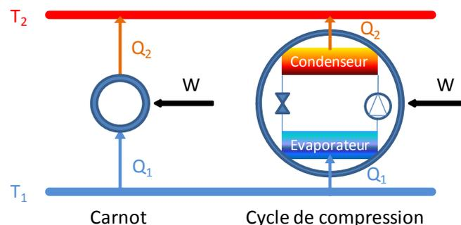
Deux échangeurs thermiques assurent les transferts thermiques du puits au cycle et du cycle à la source, avec l'écart de température nécessaire entre la source et le fluide frigorigène pour permettre le transfert de chaleur.
