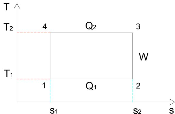
Figure 2-1 : Cycle idéal de Carnot en diagramme (T, s)
