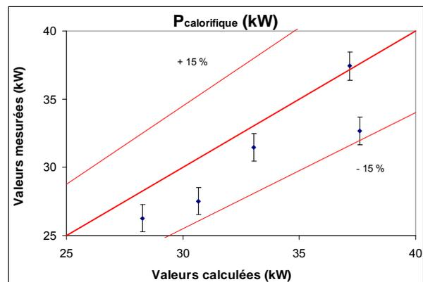
Figure 3-42: Comparaison des puissances calorifiques mesurées in-situ et calculées par le modèle de simulation
