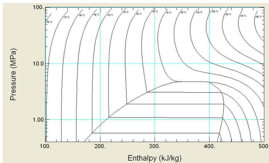
Figure Ax.2 : Diagramme P-h du fluide frigorigère R410A [REFPROP ]
