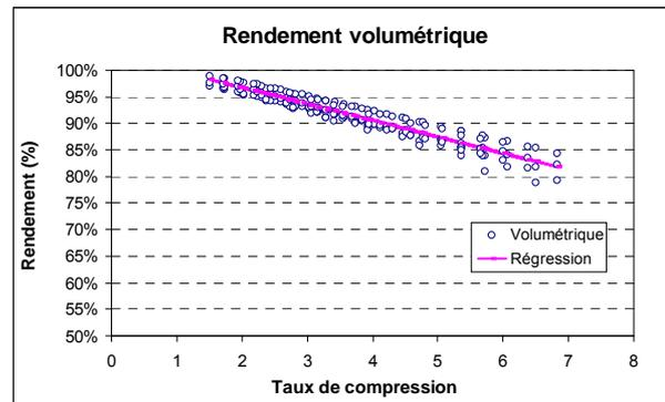
Figure 2-7 : Rendement volumétrique du compresseur
