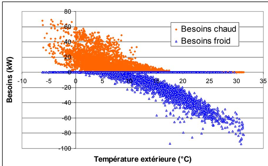
Figure 4-9 : Courbe de charge d'un bâtiment ancien à Mâcon (avec un ralenti de nuit)
