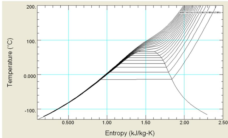
Figure Ax.1 : Diagramme T-s du fluide frigorigère R410A [REFPROP ]
