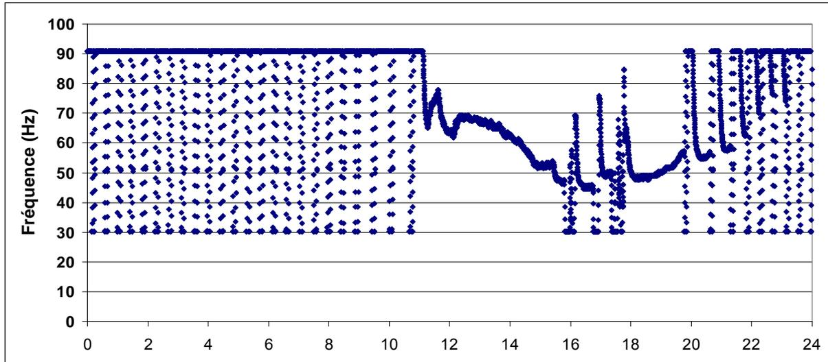
Figure 3-30 : Fréquence de rotation du compresseur lors des mesures saisies le 7 février 2008 (au pas de temps de 10 s)
