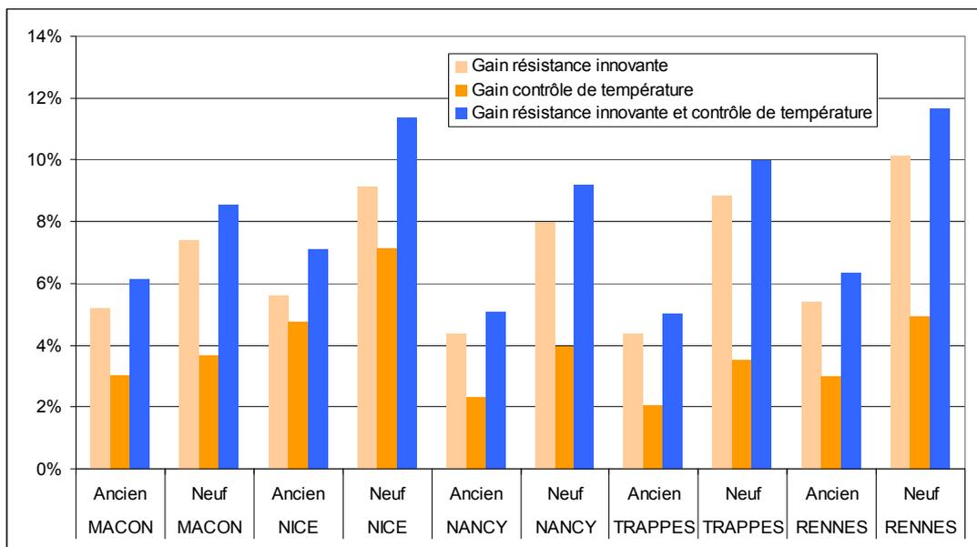
Figure 5-14 : Gain en consommation des nouvelles techniques de réchauffage des carters
