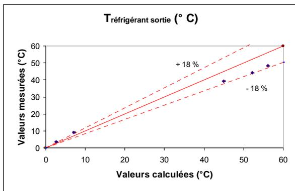
Figure 2-29 : Comparaison de la température de sortie du fluide frigorigène mesurée et calculée par le modèle
