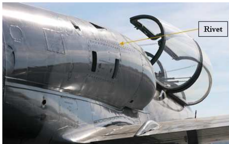
FIG. 1 – Assemblage par rivetage sur un fuselage d'avion.
