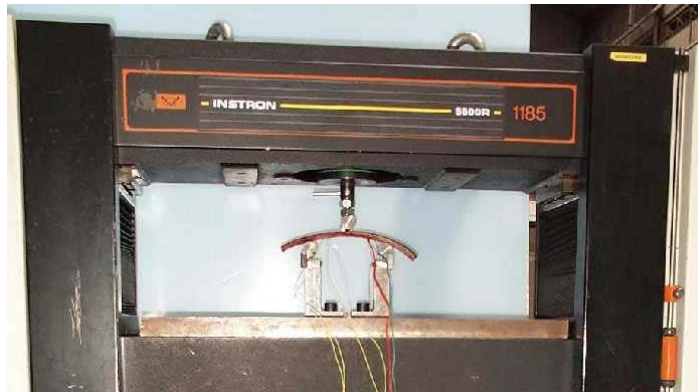
Figure 49 : Bâti et machine pour la flexion trois points (exemple : côte sciée avec jauges).
