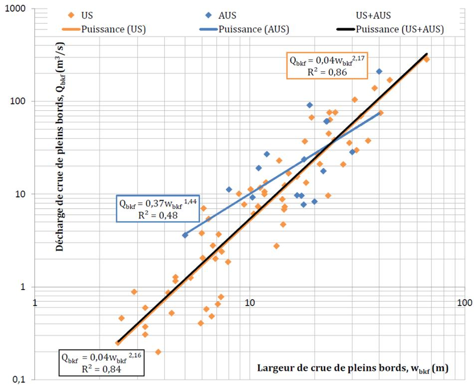
**Figure 5-19 :** Décharge de crue de pleins bords ( $Q_{bkf}$ ) exprimée en fonction de la largeur de crue de pleins bords ( $w_{bkf}$ ) pour des données de rivières issues du domaine climatique subtropical semi-humide.
