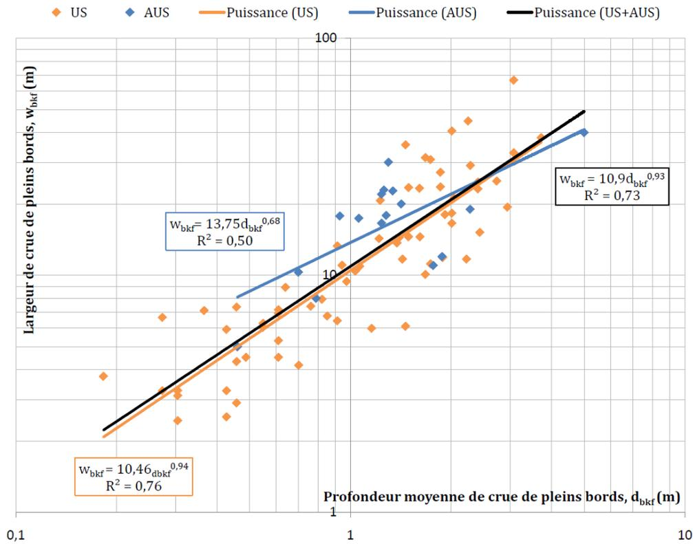
**Figure 5-13 :** Largeur de crue de pleins bords ( $w_{bkf}$ ) en fonction de la profondeur moyenne de crue de pleins bords ( $d_{bkf}$ ) pour des données de rivières issues du domaine subtropical semi-humide.
