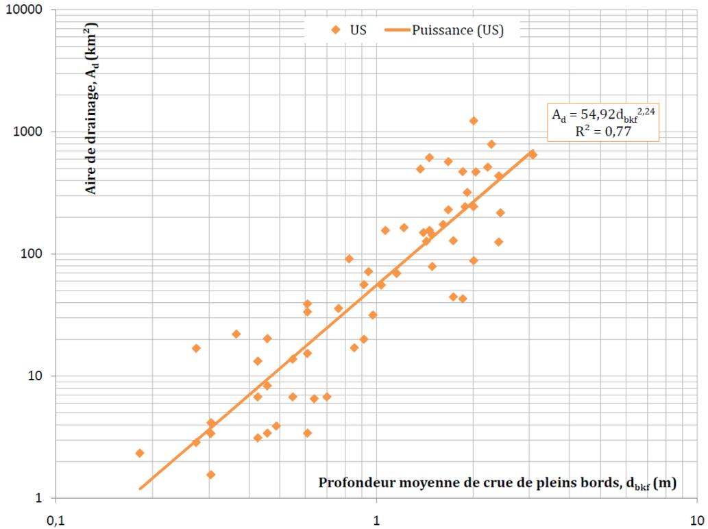
Figure 5-22 : Aire de drainage ( $A_d$ ) exprimée en fonction de la profondeur moyenne de crue de pleins bords ( $d_{bkf}$ ) pour des données de rivières issues du domaine climatique subtropical semi-humide.
