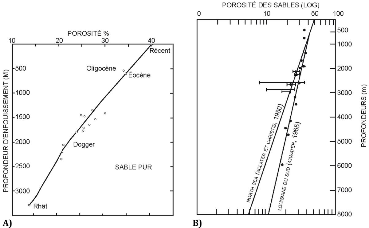
**Figure 5-3 :** **A)** Diagramme de compaction exprimant la diminution de porosité d'un sable pur en fonction de la profondeur d'enfouissement (basé sur des données du Jurassique inférieur à Quaternaire ; Wolf et Chilligarian, 1975). **B)** Courbes porosité/profondeur pour des sables (Sclater et Christie, 1980).
