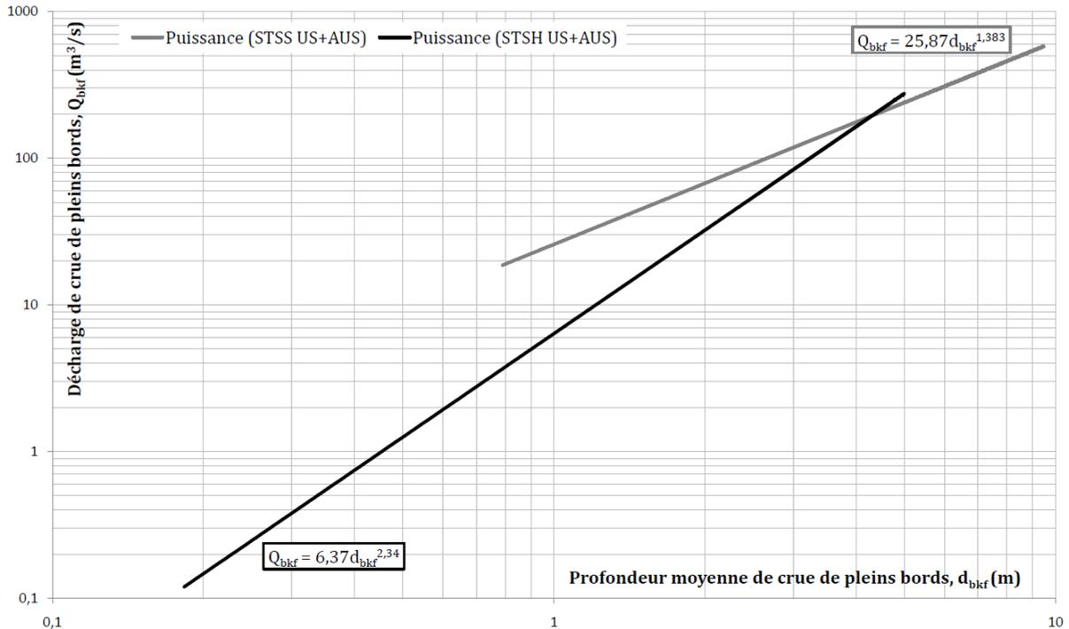
**Figure 5-18 :** Comparaisons des lois Décharge / Profondeur des domaines subtropicaux semi-humides (STSH) et à saisons sèches (STSS).
