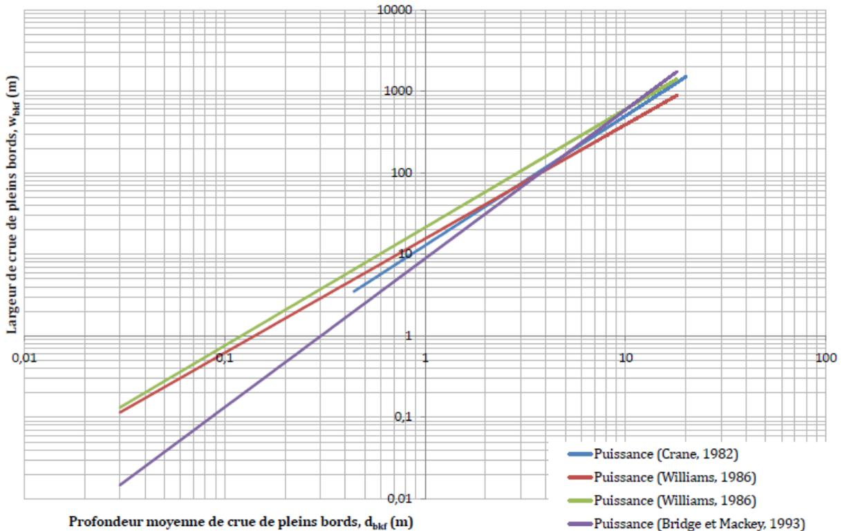
**Figure 5-5 :** Largeur de crue de pleins bords  $w_{bif}$  en fonction de la profondeur moyenne de crue de pleins bords exprimée en fonction des équations présentées dans le Tableau 5-1.
