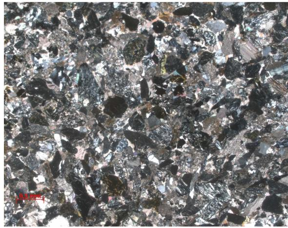
**Figure 6-10 : A & B** Photos en LPA de lames minces réalisées dans les Grès Verts du synclinal de Barrême. Soumis à FragScan, ces clichés n'ont fourni aucun résultat statistique sur la taille moyenne des grains.
