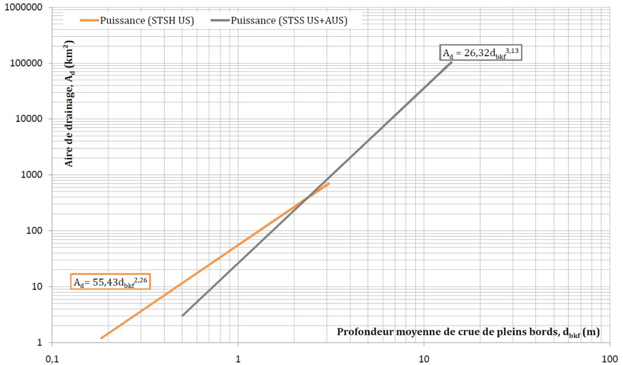
**Figure 5-24 :** Comparaisons des relations Aire de drainage / Profondeur des domaines subtropicaux semi-humides (STSH) et à saisons sèches (STSS).
