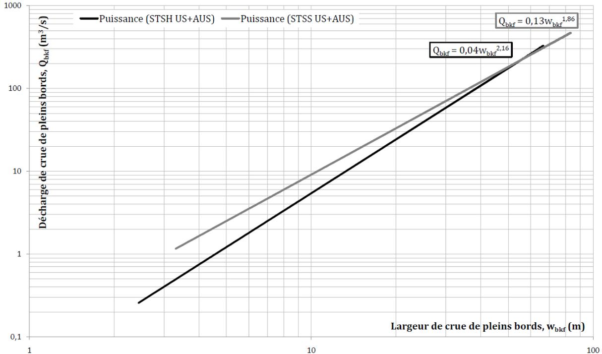
**Figure 5-21 :** Comparaison des lois entre Décharge et Largeur des domaines subtropicaux semi-humides (STSH) et à saisons sèches (STSS).
