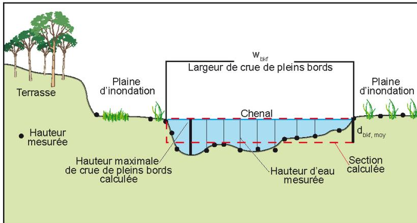
**Figure 5-12 :** Coupe schématique à travers une section droite de chenal montrant les paramètres mesurés. Les hauteurs mesurées sur toute la section du chenal permettent par la suite de calculer une aire de section de chenal (d'après Fitzpatrick et *al.*, 1998).
