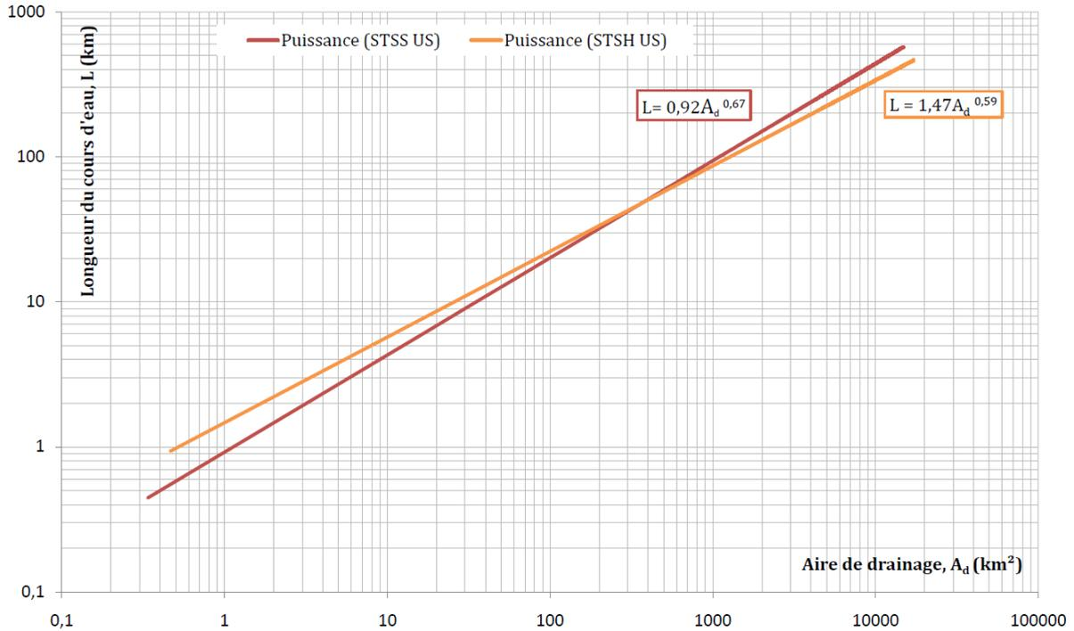
**Figure 5-30 :** Comparaison des lois entre Longueur de cours d'eau et Aire de bassin versant des domaines subtropicaux semi-humides (STSH) et à saisons sèches (STSS).
