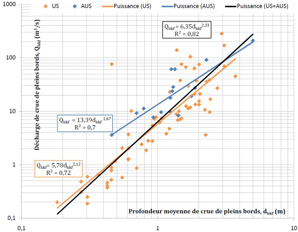
**Figure 5-16 :** Décharge de crue de pleins bords ( $Q_{bkf}$ ) exprimée en fonction de la profondeur moyenne de crue de pleins bords ( $d_{bkf}$ ) pour des données de rivières issues du domaine climatique subtropical semi-humide.
