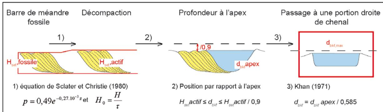
**Figure 5-4** : Synthèse sur les corrections permettant de convertir une hauteur de barre de méandre fossile en hauteur d'eau de crue de pleins bords moyenne.
