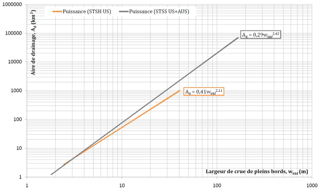
**Figure 5-27 :** Comparaison des relations entre Aire de drainage et Largeur des domaines subtropicaux semi-humides (STSH) et à saisons sèches (STSS).
