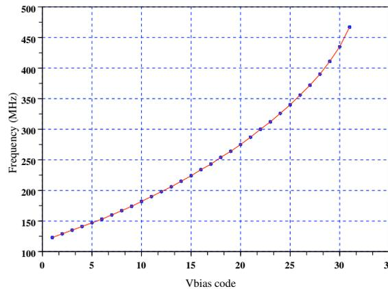
FIG. 3.3 – La plage de fréquences couverte par le DCO en fonction du mot bias pour CT=1
