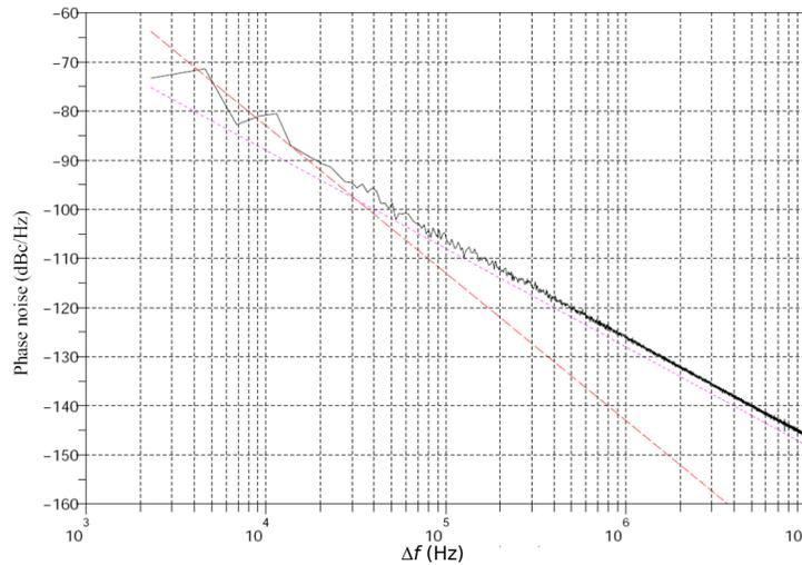
FIG. 1.12 – La densité spectrale de puissance du DCO. Le point  $\omega_1/f_3$  est vu à 30kHz
