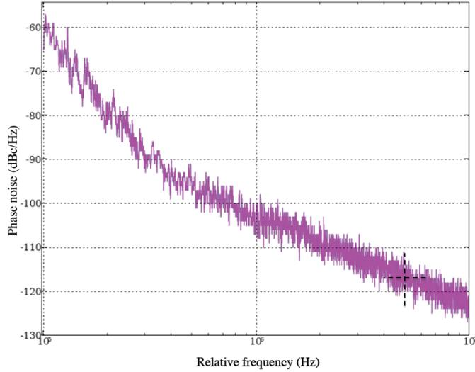
FIG. 3.4 – Le bruit de phase mesuré de CKV  $f_{CKV}=470\text{MHz}$
