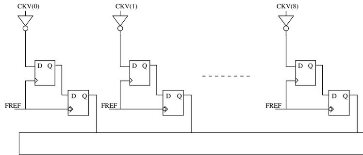
FIG. 2.8 – Le schéma bloc du TDC
