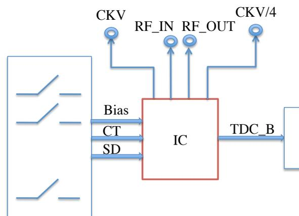
FIG. 3.1 – Schéma bloc de la carte de test de la boucle ouverte
