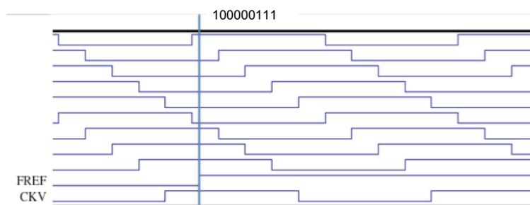
FIG. 1.5 – Le calcul de  $t_r$  et  $t_f$  par le TDC
