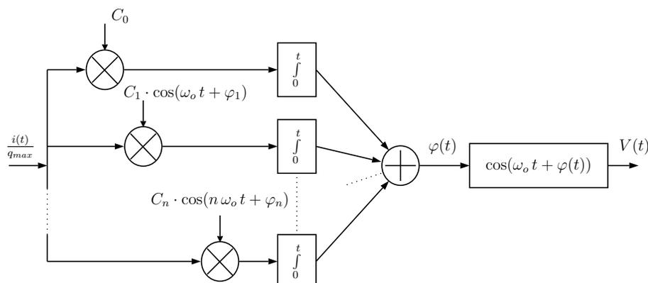
FIG. 1.10 – Les blocs du modèle de VCO
