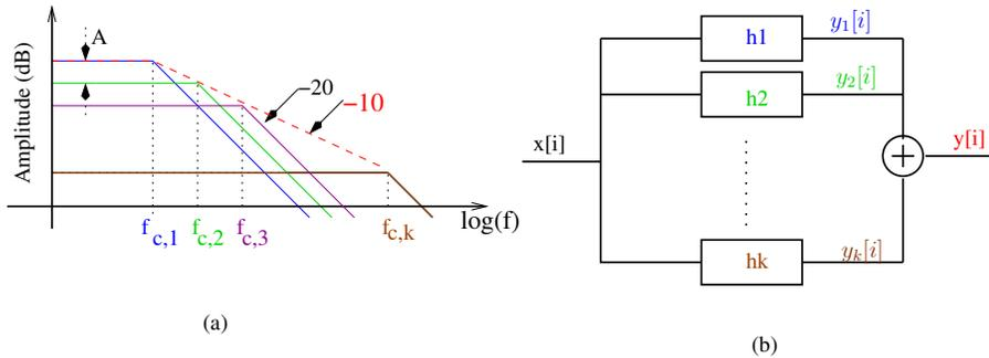
FIG. 1.9 – (a) : La composition de la pente -10dB à partir de la somme de bruit blanc filtré passe bas -20dB. (b) : Schéma block du générateur de bruit en  $1/f$ .
