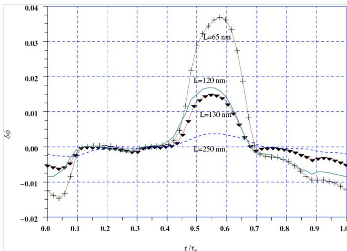
FIG. 2.5 – La fonction ISF de l’oscillateur interpolateur pour  $L = (65\text{nm}, 120\text{nm}, 130\text{nm}, 250\text{nm})$
