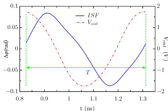
FIG. 1.11 – Les variations de l'ISF en fonction du temps et de la phase du signal oscillant
