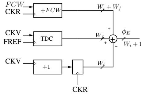
FIG. 1.2 – Le diagramme du détecteur de phase. CKR est le signal Fref après la synchronisation par CKV
