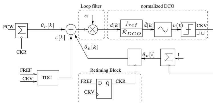
FIG. 1.1 – La boucle à verrouillage de phase numérique de [3]
