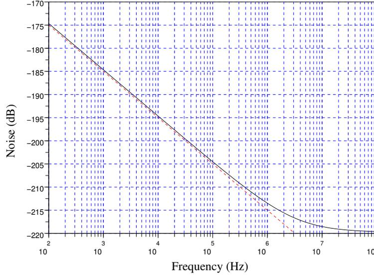
FIG. 1.8 – Le bruit CMOS de l'oscillateur LC. C'est le résultat de l'analyse noise de Spectre
