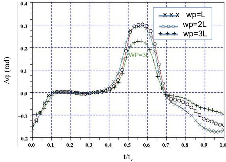
FIG. 2.6 – La fonction ISF de l'oscillateur interpolateur
