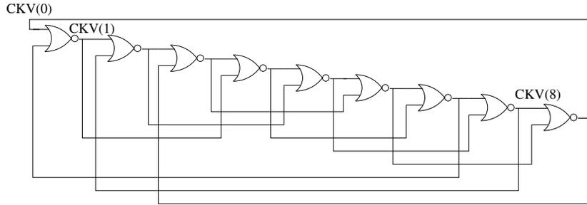
FIG. 2.3 – Un oscillateur interpolateur (9,7) en anneau à cellule NOR de deux ports
