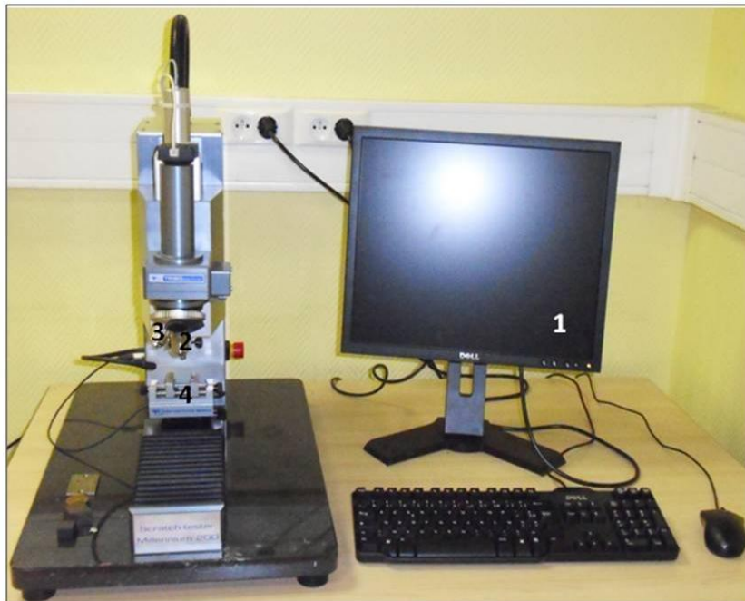
Fig. II.3.2a. Scratch- tester Millennium du CER Arts et Métiers ParisTech Lille (1) Ordinateur – (2) Indenteur – (3) Objectif – (4) Porte-substrats
