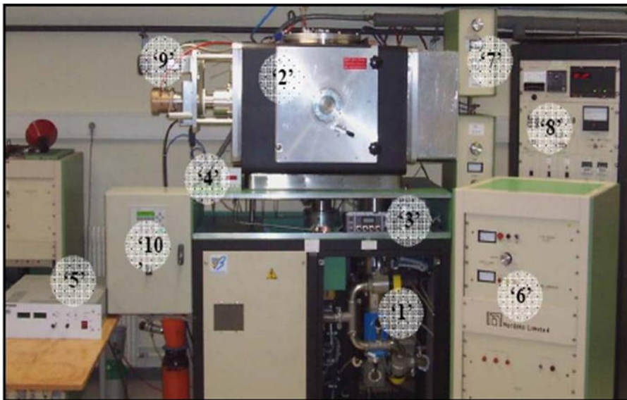
Figure II.1.1a. Bâti de pulvérisation magnétron : '1' système de pompage, '2' enceinte de dépôt, '3' débitmètres massiques, '4' lecteur de pression, '5' alimentation DC, '6' générateur RF 13,56 MHz, '7' adaptateur d'impédance, '8' cadran de contrôle, '9' moteur de rotation du porte-substrats (PS), '10' automate
