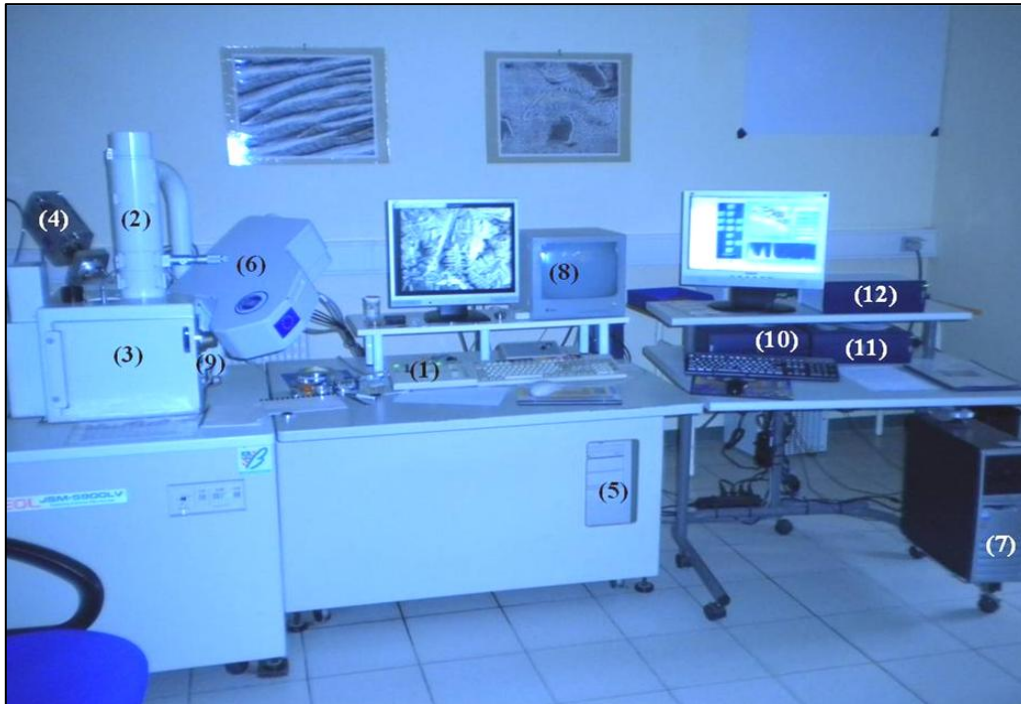
Figure II.2.2.1. Le MEB « Jeol-JSM 5900LV au CER Arts et Métiers ParisTech de Cluny : (1) Boîtier de pilotage manuel, (2) Colonne électronique permettant de générer et piloter le faisceau d'électrons, (3) Chambre, (4) Détecteur EDS (X-add) à refroidissement par effet Peltier, (5) PC de pilotage du MEB et d'acquisition d'images, (6) Détecteur WDS, (7) Analyseur multicanal destiné à traiter et amplifier les informations en provenance des détecteurs, (8) Ecran de la caméra infrarouge, (9) Caméra infrarouge, (10) Boîtier d'acquisition (EDS), (11) Boîtier d'acquisition de l'image, (12) Boîtier d'acquisition (WDS)
