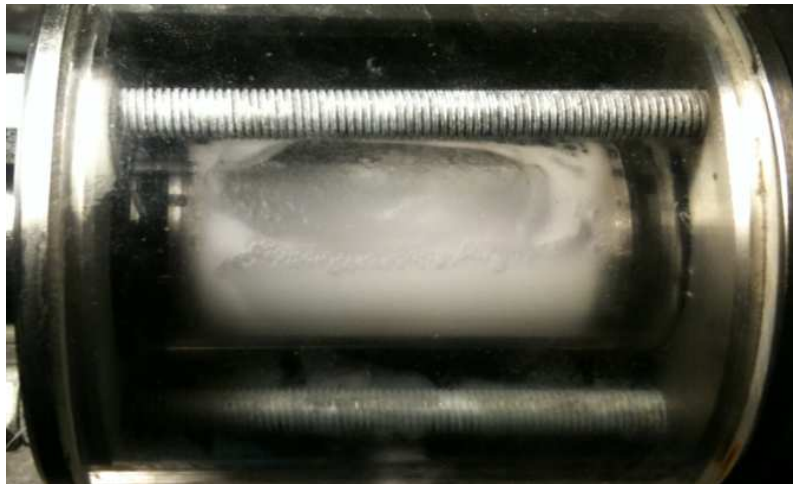
Figure IV.14. Aspect d'un coulis d'hydrates mixtes TBPB-CO 2 (taux volumique d'hydrate de 8,6 %)
