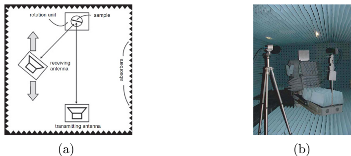
Figure II.8 – Schéma [22] et photographie [21] du dispositif bi-statique
