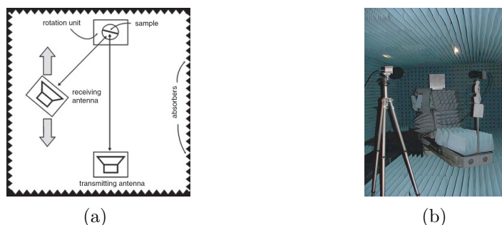
Figure II.8 – Schéma [22] et photographie [21] du dispositif bi-statique
