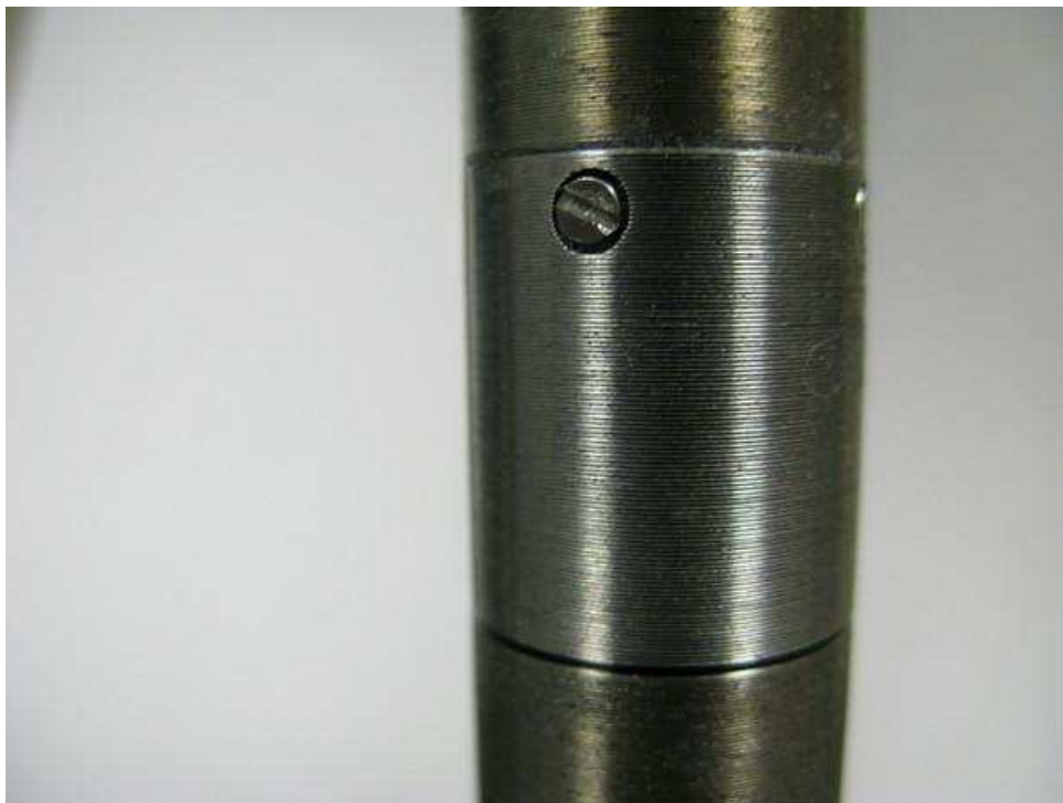
Figure 32 - Coques de protection des jauges (même matériau que le pieu)
