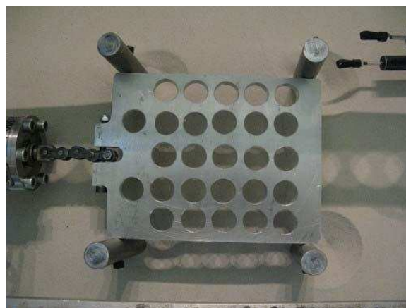
(b) Entretoise utilisée pour un essai à la rupture avec un espacement de e=8B
