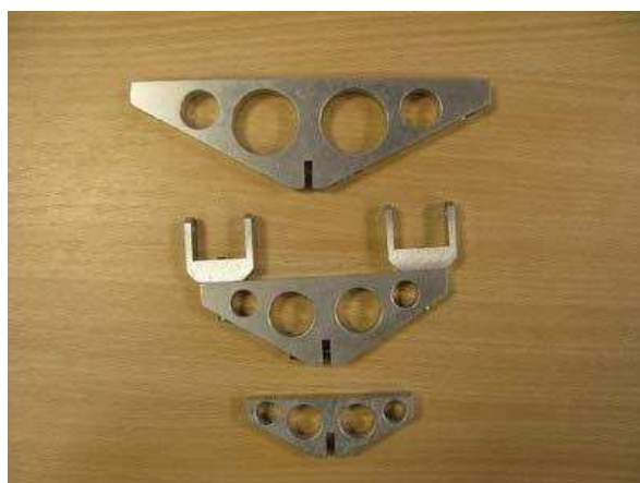
(a) Pièces mécaniques de liaison avec le servovérin et qui permettent de conserver un espacement constant entre les pieux d'une rangée
