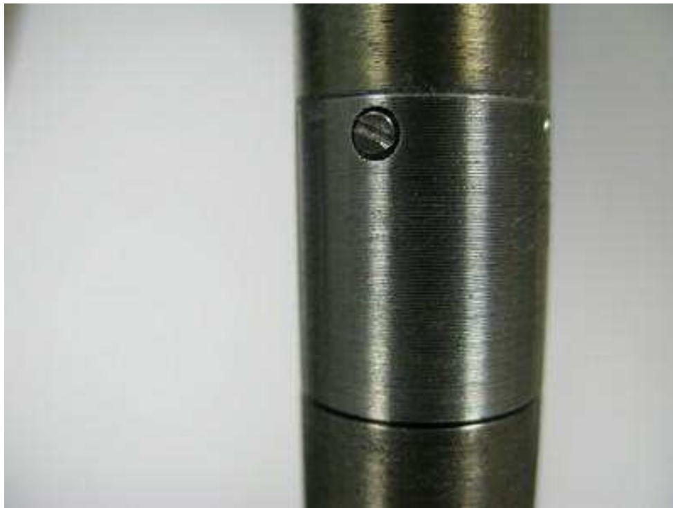
Figure 2-29 - Coques de protection des jauges
