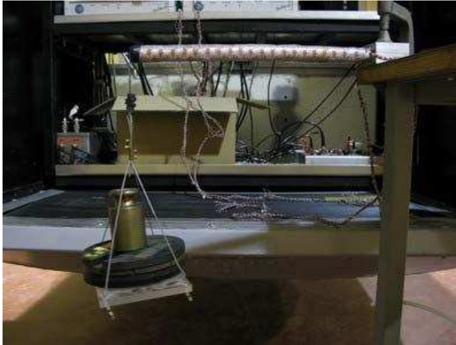
Figure 6 - Dispositif d'étalonnage du pieu
