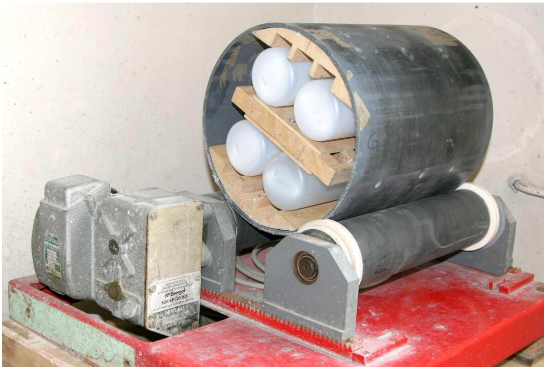
FIG. 2.2 : Fabrication des éprouvettes de pâtes de ciment dans des moules P.V.C. en rotation.
