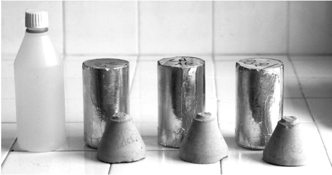
FIG. 4.8 : Photographie des éprouvettes de pâte de ciment qui sont fabriquées dans les bouteilles en rotation et ensuite sciées en deux parties.
