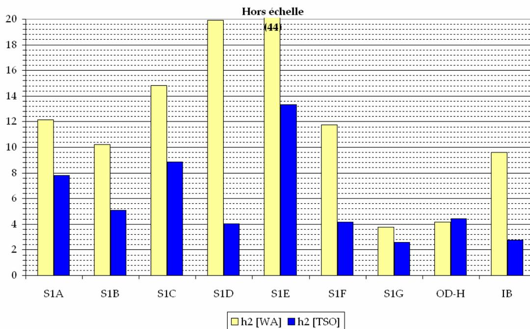
**Figure III-13 : Hauteurs de plateaux réduites des colonnes « sirius1 » (conditions de référence – TSO : 10% IPA – warfarine : 20% IPA)**
