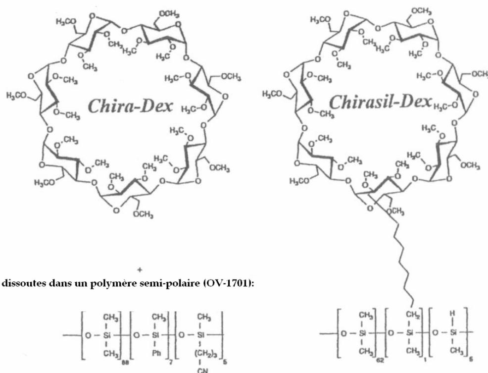
Figure II-3 : Exemple de PSC à base de  $\beta$ -cyclodextrines pour la CPG (la cyclodextrine est dissoute ou greffée de manière covalente à un polymère, dont le support est ensuite imprégné)<sup>70</sup>
