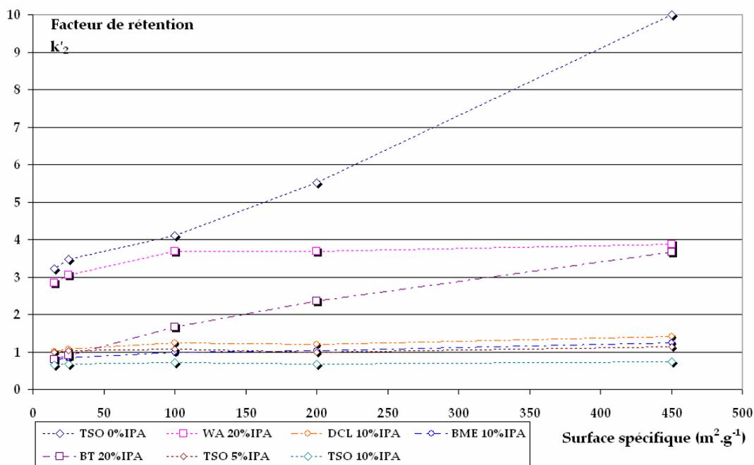
**Figure II-3 : Evolution du facteur de rétention avec la porosité de la silice (conditions chromatographiques de référence).**
