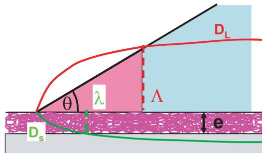
FIGURE 5.11 – (—) profil de la goutte, (—) profil de diffusion du polymère dans le liquide avec un coefficient de diffusion  $D_{liq} = 10^{-9} \text{ mm}^2/\text{s}$ , (—) profil de diffusion de l'eau dans le polymère avec un coefficient de diffusion  $D_{sol} = 10^{-11} \text{ mm}^2/\text{s}$
