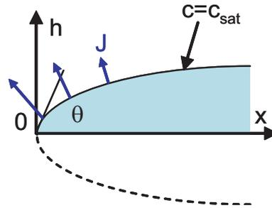
FIGURE 1.24 – Une analogie entre l'évaporation et l'électromagnétisme permet de déterminer la forme de l'expression du flux d'évaporation  $J$ .
