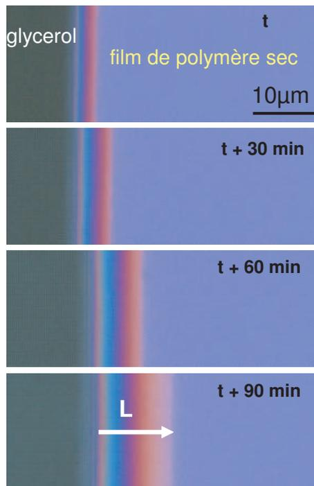
FIGURE 4.8 – A l'aide d'un microscope optique ( $\times 20$ ) on peut suivre l'évolution au cours du temps la position du front de diffusion du glycérol dans le film de PDMA devant la ligne de contact macroscopique. La goutte est à gauche de l'image, en gris. Le film de PDMA apparaît bleu lavande.
