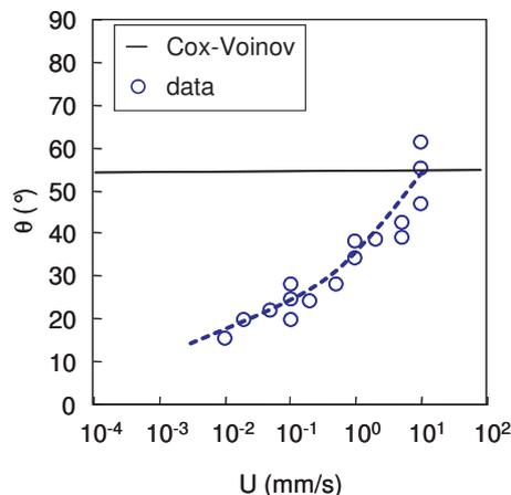
FIGURE 5.1 – Variation de l'angle de contact en fonction de la vitesse de la ligne triple.
