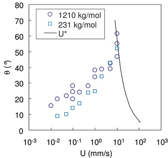
FIGURE 5.13 – Variation de l'angle de contact en fonction de la vitesse de la ligne triple pour des films d'épaisseur  $e = 8 \text{ nm}$  à différentes masses molaires de PDMA. La ligne continue représente la courbe de la vitesse critique en dessous de laquelle la dissolution est effective.
