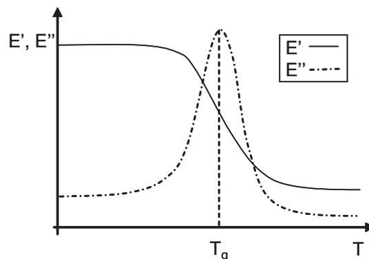
FIGURE 1.2 – Variation des modules de conservation ( $E'$ ) et de perte ( $E''$ ) en fonction de la température. A  $T_g$ , le module de conservation varie brusquement et le module de perte atteint un maximum.
