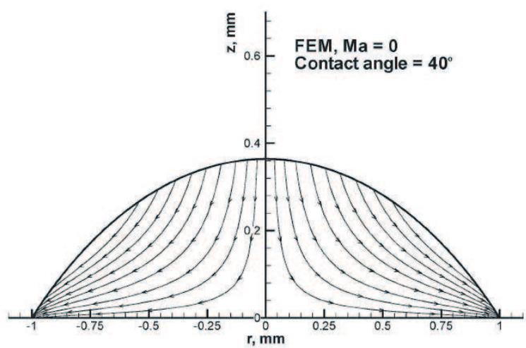
FIGURE 1.26 – Lignes de courant dirigées vers la ligne de contact dans une goutte d'eau au cours de l'évaporation [34].
