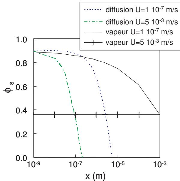
FIGURE 5.18 – Profil de la fraction d'eau  $\phi$  apportée par la phase vapeur ou la diffusion ( $\phi_0 = 0.9$ ).
