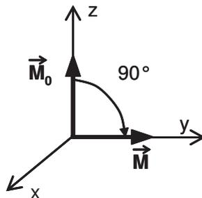
FIGURE B.1 – Application d'un pulse à  $90^\circ$  à l'aimantation  $\vec{M}$ .
