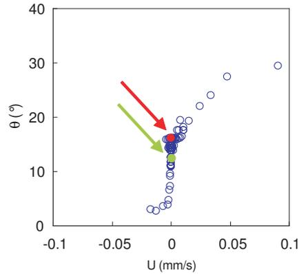
FIGURE 4.13 – Le front de diffusion apparaît (flèche rouge) juste au moment où il y a un changement de comportement de  $\theta(U)$ . Le front de diffusion a une largeur de  $30 \mu\text{m}$  environ et existe pour  $0 < U < 1 \mu\text{m/s}$  (flèches rouge et verte).
