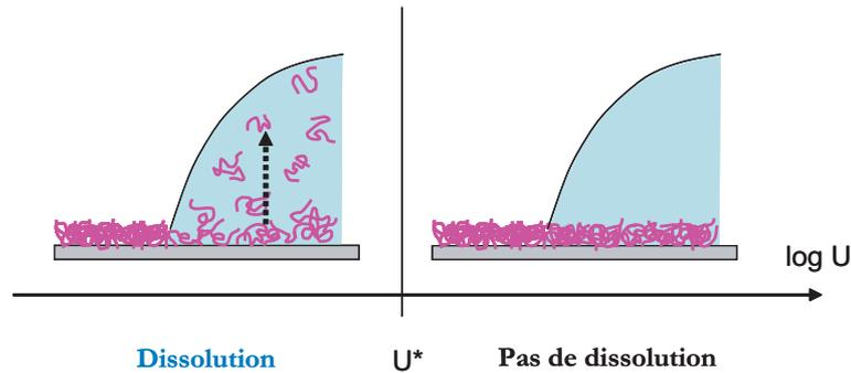
FIGURE 5.2 – Il existe une vitesse critique  $U^*$  en-dessous de laquelle le polymère se dissout dans la goutte d'eau.
