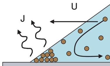
FIGURE 1.32 – La divergence d'évaporation entraîne les particules vers la ligne de contact, tandis que le mouvement de la ligne triple les redisperse.
