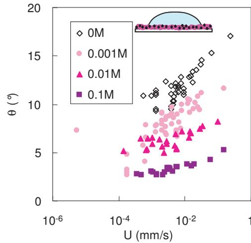
FIGURE 3.31 – Variation de l'angle de contact en fonction de la vitesse de la ligne triple pour différentes concentrations en sel dans la solution de préparation d'un film de polyzwitterion ( $e \simeq 15 \text{ nm}$ ).
