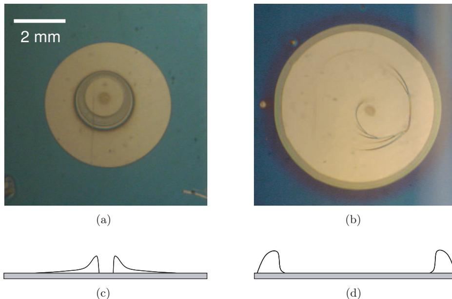
FIGURE 3.21 – Figures de séchage d'une goutte d'eau posée sur un film de (a,c) PDMA (b,d) PDADMAC. Un schéma du profil du dépôt est placé sous chaque image.
