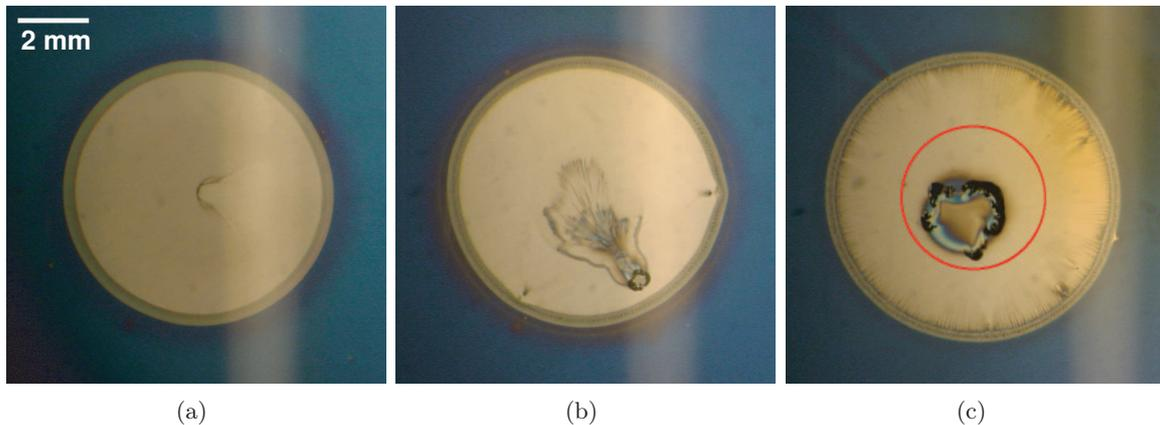
FIGURE 3.23 – Figures de séchage d'une goutte d'eau salée posée sur un film de PDADMAC à différentes concentrations en sel (a)  $10^{-3}$  mol/L (b)  $10^{-2}$  mol/L (c)  $10^{-1}$  mol/L.
