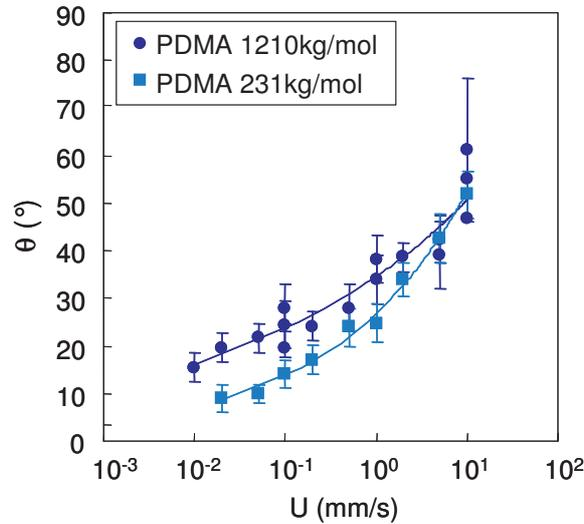
FIGURE 3.10 – Variation de l'angle de contact en fonction de la vitesse de la ligne triple pour des films d'épaisseur  $e = 8 \text{ nm}$  à différentes masses molaires de PDMA. Courbe obtenue en poussant une goutte de volume  $20 \mu\text{L}$ .
