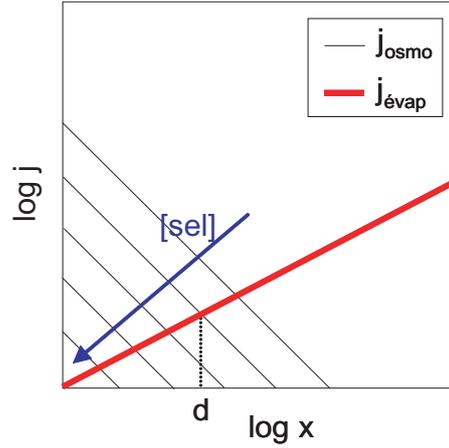
FIGURE 5.29 – Flux osmotique et évaporatif en fonction de la distance au bord de la goutte.
