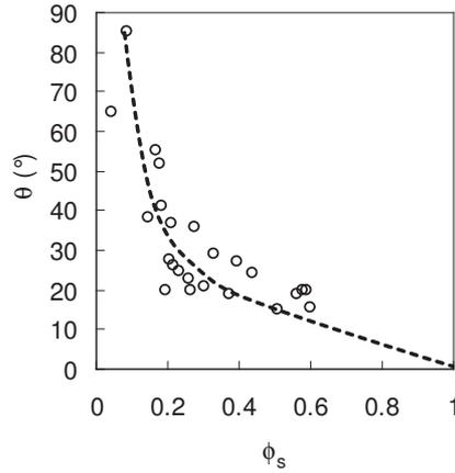
FIGURE 5.5 – Plus un film de polymère contient d'eau, plus il est mouillant.
