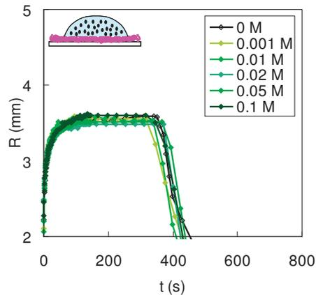
FIGURE 5.20 – Evolution du rayon de la goutte au cours du temps pour différentes concentrations de sel dans la goutte. ( $e \sim 100 \text{ nm}$ )
