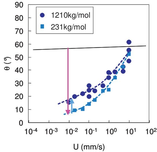
FIGURE 5.14 – Variation de l'angle de contact en fonction de la vitesse de la ligne triple. (—) Loi de Cox-Voinov ( $\theta_e = 55^\circ$ ) (●)  $M_n = 1210 \text{ kg/mol}$  (■)  $M_n = 231 \text{ kg/mol}$  (↓) Amplitude de l'effet de préhydratation (↑) Amplitude de l'effet de dissolution.
