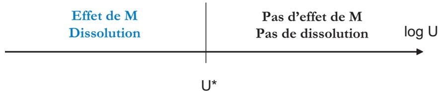
FIGURE 3.14 – Il existe une vitesse critique  $U^*$  en-dessous de laquelle la masse molaire du polymère affecte l'angle de contact.
