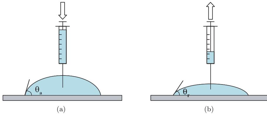
FIGURE 1.18 – Angles d'avancée (a) lorsque la goutte est gonflée et de reculée (b) lorsque l'on vide la goutte par aspiration.
