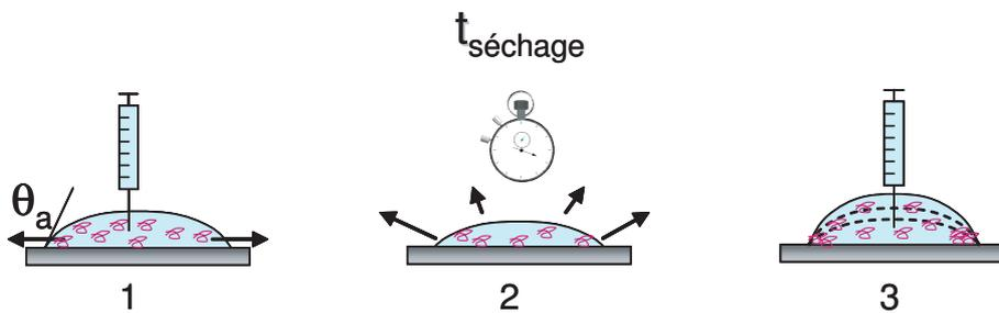
FIGURE 3.1 – Dans un premier temps, (1) une goutte de solution de PDMA est posée sur un substrat en verre abrasé et rincé à l'éthanol. (2) La goutte ensuite est laissée à sécher pendant un temps  $t_{\text{séchage}}$ . (3) Au bout de ce temps, la goutte est gonflée à l'aide d'une seringue avec la même solution qu'à l'étape (1).
