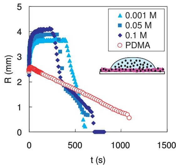
FIGURE 5.25 – *Evolution du rayon d'une goutte posée sur un film de PDADMAC à différentes teneur en sel et sur un film de PDMA.*
