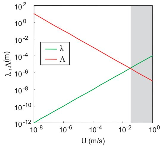
FIGURE 5.12 – Variation des longueurs caractéristiques de diffusion en fonction de la vitesse de la ligne de contact. La zone non grisée représente le domaine où l'effet de viscosité est optimal.
