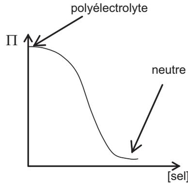
FIGURE 5.27 – Variation schématique de la pression osmotique en fonction de la concentration en sel.
