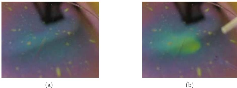
FIGURE 4.3 – Mise en évidence du gonflement d'une film de polymère hydrophile par l'eau en phase gazeuse : (a) Avant - (b) Gonflement du film (jaune) localisé sous le jet d'air humide sortant de la pipette pasteur.
