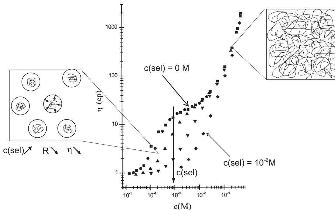
FIGURE 1.13 – Variation de la viscosité de solutions de Poly(styrène-sulfonate) en fonction de la concentration en polymère. (■) sans sel ajouté, (●)  $[NaCl] = 10^{-5} \text{ mol/L}$ , (▲)  $[NaCl] = 10^{-4} \text{ mol/L}$ , (▼)  $[NaCl] = 10^{-3} \text{ mol/L}$ , (◆)  $[NaCl] = 10^{-2} \text{ mol/L}$ . [11]
