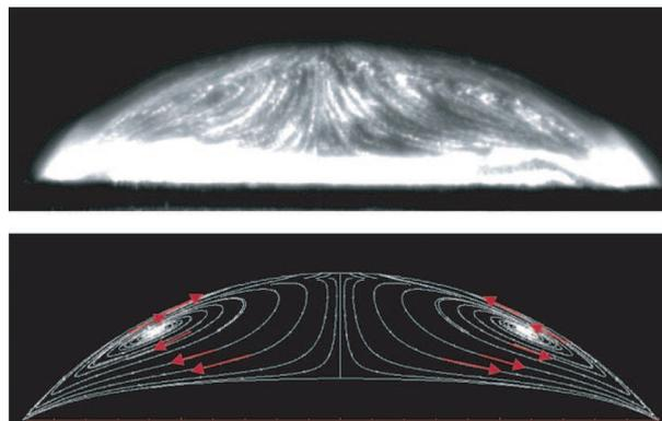
FIGURE 1.27 – Lignes de courant d'une goutte d'octane soumise à l'évaporation [36]. En haut, la figure expérimentale obtenue en suivant des traceurs fluorescents, en bas, les lignes de courant prédites par la simulation.
