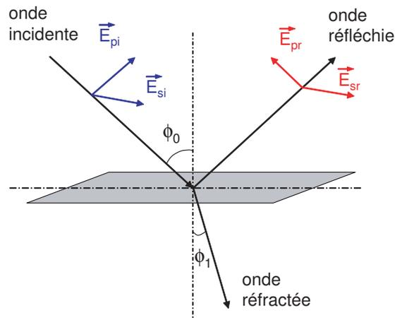
FIGURE A.1 – La polarisation du champ électrique est modifiée après réflexion sur une surface.
