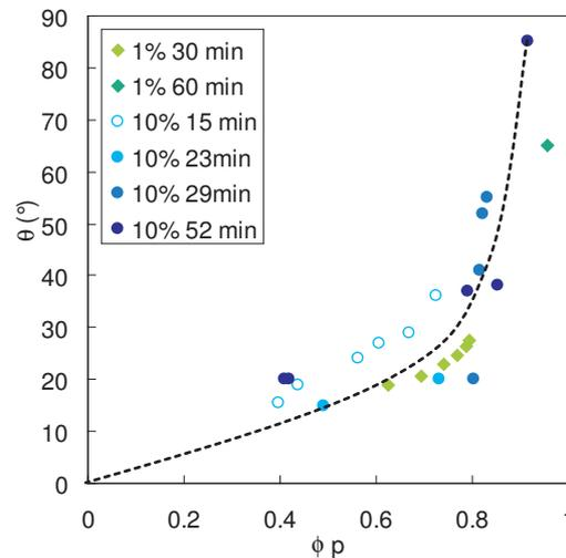
FIGURE 3.4 – Variation de l'angle de contact en fonction de la fraction en polymère dans le substrat. (La ligne en pointillés est un guide pour l'oeil)
