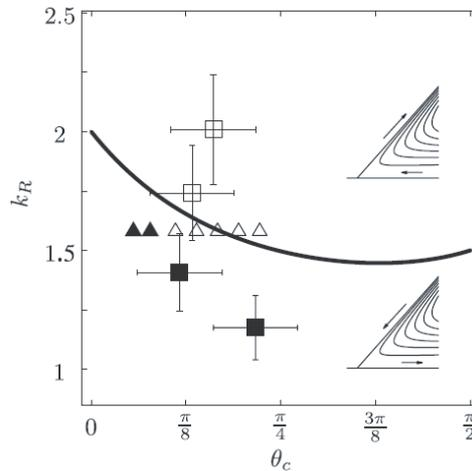
FIGURE 1.29 – En fonction de l'angle de contact  $\theta_c$  et du rapport des conductivités thermiques du substrat et du liquide,  $k_R \equiv \frac{k_s}{k_l}$ , le sens des lignes de courant peut changer.
