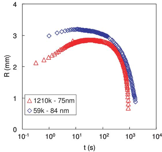
FIGURE 3.8 – Evolution du rayon de la goutte au cours du temps pour des films de PDMA à différentes masses molaires et d'épaisseur  $e \sim 80$  nm.
