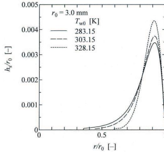
FIGURE 1.33 – Profils de dépôt de colloïdes obtenus par simulation numérique [42].
