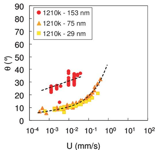
FIGURE 3.7 – Evolution de l'angle de contact (mesuré) en fonction de la vitesse de la ligne triple pour différentes épaisseurs de films de PDMA  $M_n = 1210$  kg/mol.
