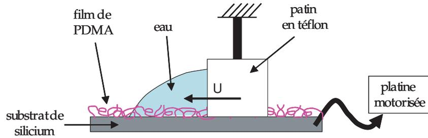
FIGURE 2.5 – Montage d'étude de l'angle en fonction de la vitesse pour les grandes vitesses. Dans le référentiel du substrat, la goutte est poussée à une vitesse  $U$ .
