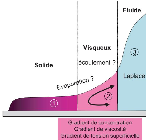
FIGURE 5.22 – Il existe trois zones où les concentrations en soluté sont très différentes : ③ une zone fluide, qui peut être considérée comme celle de la goutte, ① une zone solide constituée du film de polymère non préhydraté et ② une zone intermédiaire qui raccorde les deux premières. Les profils de concentration, de taux d'évaporation et d'écoulement sont inconnus dans cette zone très visqueuse.
