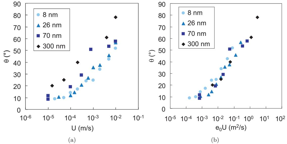
FIGURE 5.9 – Variation de l'angle de contact pour différentes épaisseur de film de PDMA ( $M = 231$  kg/mol) en fonction (a) de la vitesse de la ligne triple (b) du paramètre  $e_0 U$
