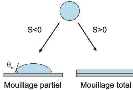
FIGURE 1.15 – Régimes de mouillage d'une goutte posée sur un substrat.
