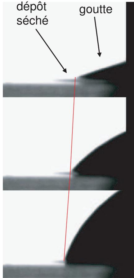
FIGURE 3.2 – Au fur et à mesure que la goutte (droite) avance sur le pied de polymère (gauche) séché, l'angle de contact augmente.
