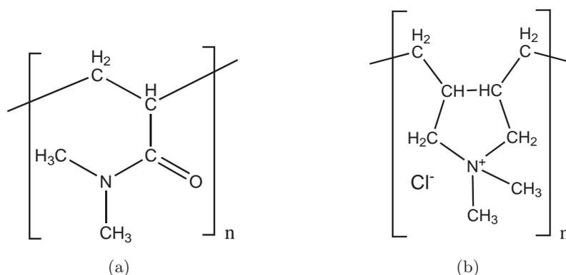
FIGURE 2.1 – Formules chimiques du (a) PDMA et du (b) PDADMAC.
