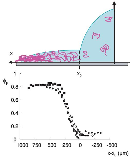
FIGURE 3.3 – Evolution de la concentration en polymère le long d'un dépôt polymère au cours du séchage. Les différents symboles correspondent à différentes durées de séchage. [57]
