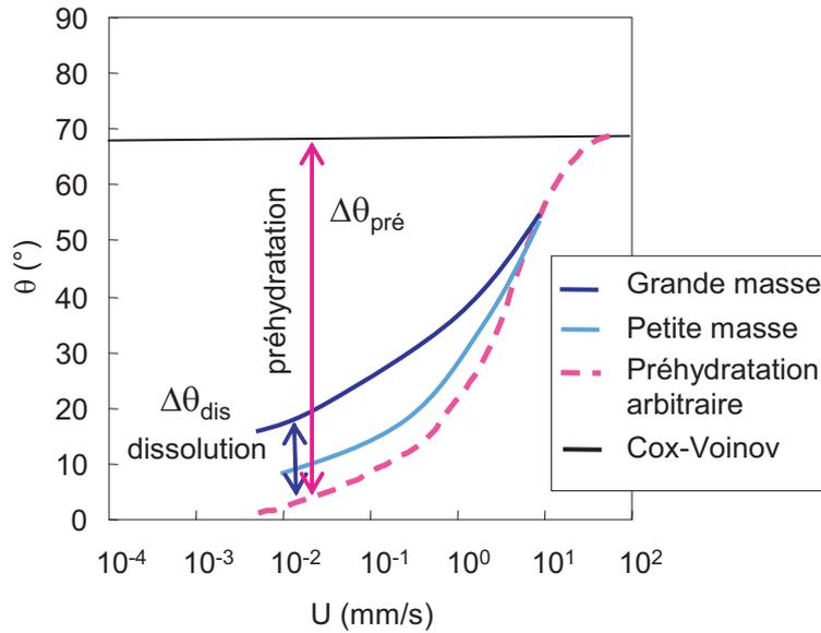
FIGURE 5.19 – Effet de la préhydratation et de la dissolution sur l'angle de contact.
