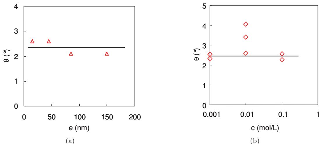
FIGURE 3.33 – Variation de l'angle de décrochage de la ligne de contact en fonction (a) de l'épaisseur du film et (b) de la concentration en sel dans la solution de préparation des films de PZ. Ces angles ont été calculés à partir du rayon de la goutte à chaque instant en supposant que le taux d'évaporation est constant.
