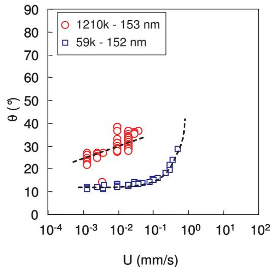
FIGURE 3.9 – Variation de l'angle de contact en fonction de la vitesse de la ligne triple pour des films d'épaisseur  $e \sim 150$  nm à différentes masses molaires de PDMA.
