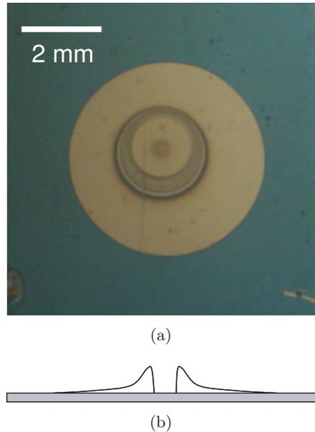
FIGURE 3.12 – Profil (b) et figure (a) de séchage sur un film de PDMA après évaporation de la goutte.
