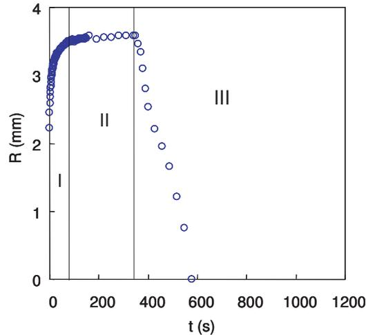
FIGURE 3.17 – Evolution du rayon de la goutte au cours du temps pour le PDADMAC. On distingue trois phases : (I) phase d'étalement, (II) phase d'accrochage de la ligne de contact et (III) phase de reculée de la ligne de contact.
