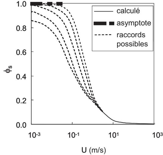
FIGURE 5.7 – Variation de la fraction d'eau dans le film de polymère gonflé  $\phi_s$  en fonction de la vitesse de la ligne de contact  $U$ .
