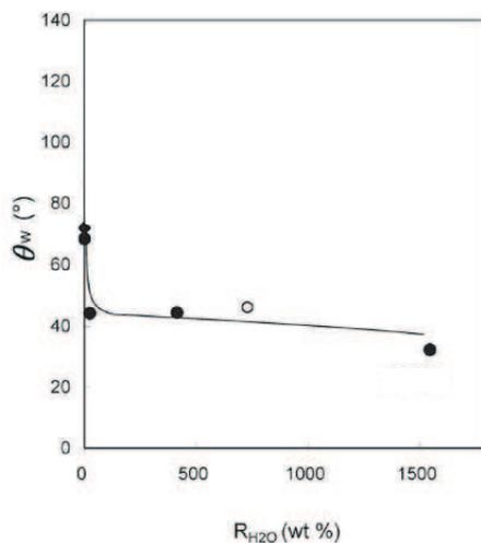
FIGURE 1.20 – L'angle de contact sur un gel de PDMA dépend de la teneur en eau du gel. [26]
