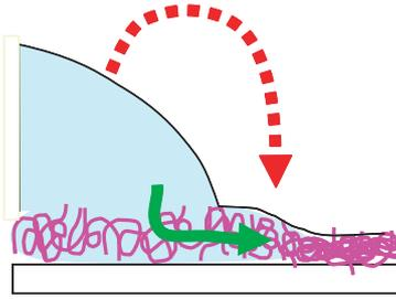
FIGURE 4.2 – Mécanismes possibles de transfert d'eau dans le film de polymère.
