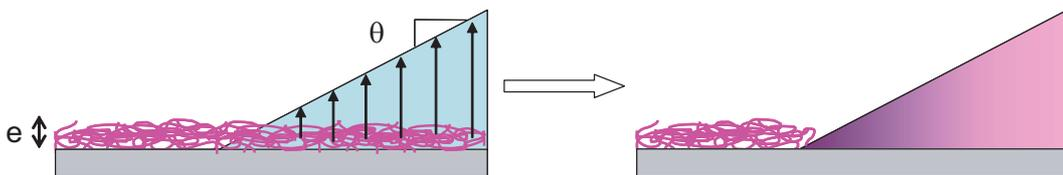
FIGURE 5.28 – Profil de concentration de polymère : le polymère se dissout dans la goutte en diffusant verticalement.
