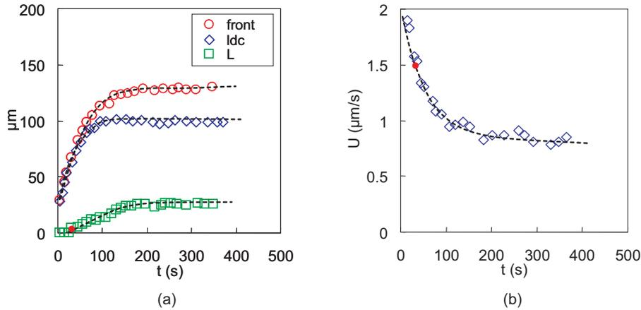
FIGURE 4.12 – (a) En relevant la position de la ligne de contact ( $\circ$ ) et celle du front de diffusion ( $\diamond$ ), on déduit par différence la largeur du front de diffusion  $L$  au cours du temps ( $\square$ ). Le point rouge correspond à l'instant où le front de diffusion apparaît. (b) Vitesse de la ligne de contact. En reportant l'instant (point rouge) où le front de diffusion apparaît, on détermine la vitesse de la ligne de contact correspondant à ce moment.
