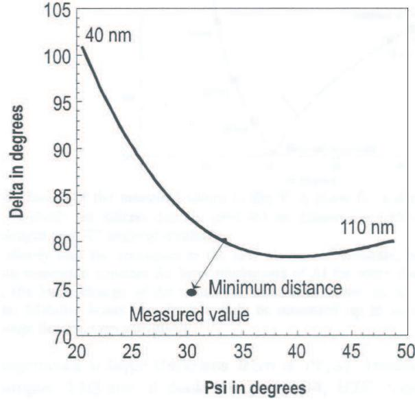
FIGURE A.3 – Adaptation d’une épaisseur de couche avec un indice de réfraction fixé à  $n=1.46$ . (Extrait de Device Driver for the Ellipsometer - SENTECH)
