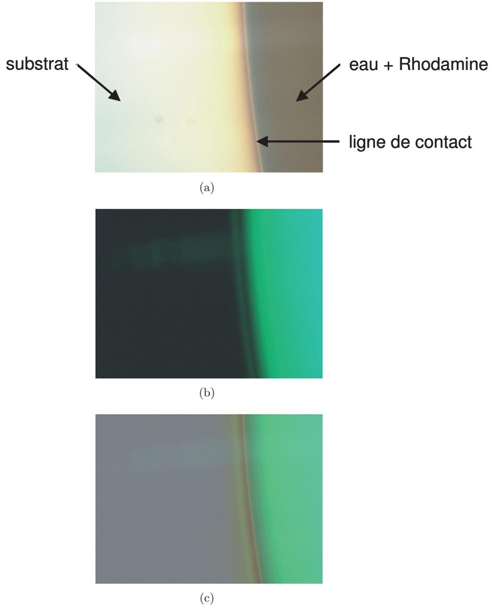
FIGURE 4.10 – (a) Vue de dessus en fond clair de la goutte d'eau contenant de la Rhodamine 6G. (b) Vue de dessus en fluorescence de la même goutte. (c) Superposition des photos (a) et (b)
