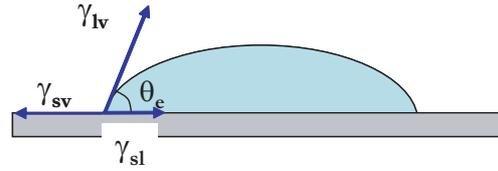
FIGURE 1.17 – En régime de mouillage partiel, la goutte fait un angle  $\theta_e$  avec le substrat.
