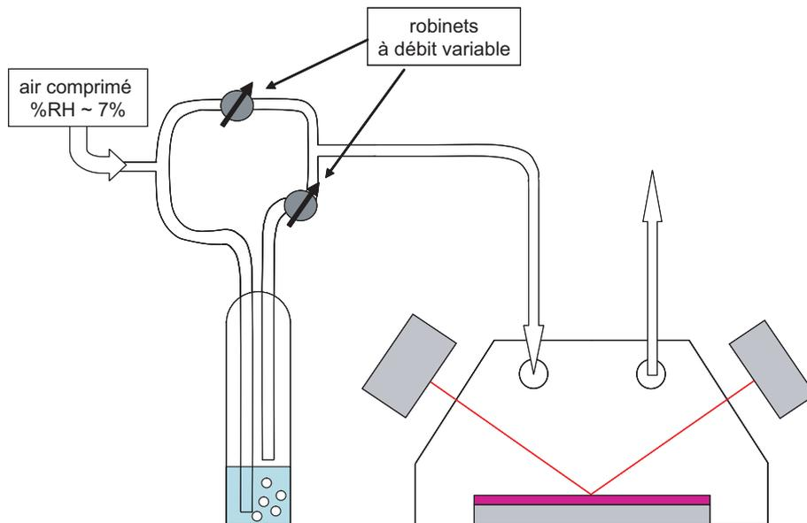
FIGURE 2.2 – De l'air à humidité contrôlée entre dans la cellule et gonfle le film de polymère (rose). La cellule est conçue de façon à ce que le faisceau laser (rouge) de l'ellipsomètre entre et sorte orthogonalement aux parois.
