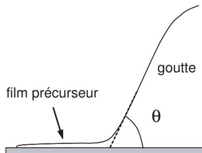
FIGURE 1.16 – En régime de mouillage total, un film précurseur de mouillage apparaît devant la ligne de contact macroscopique.
