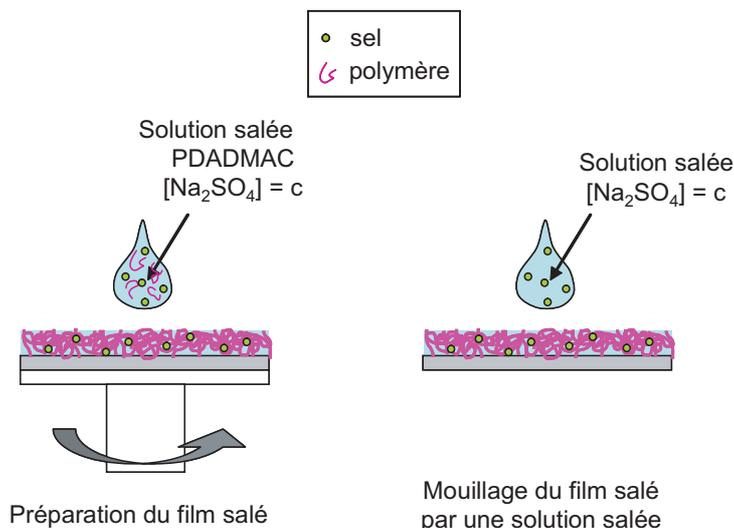
FIGURE 3.16 – Protocole de préparation d'un film de polymère contenant du sel et mouillage de ce film par une solution salée.
