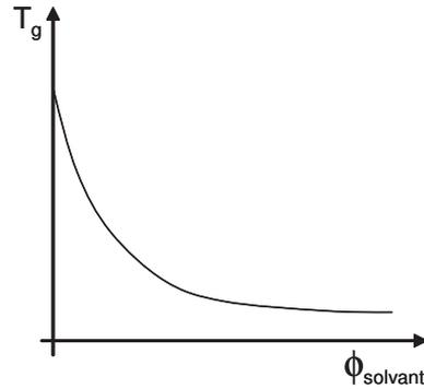
FIGURE 1.3 – Variation de la température de transition vitreuse en fonction de la fraction en solvant.
