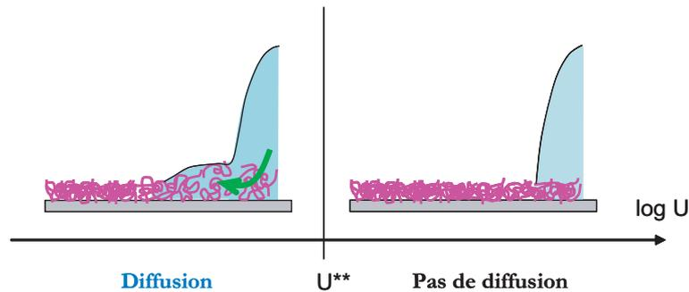
FIGURE 5.3 – Il existe une vitesse critique  $U^{**}$  en-dessous de laquelle apparaît un front de diffusion d'eau devant la ligne de contact macroscopique.
