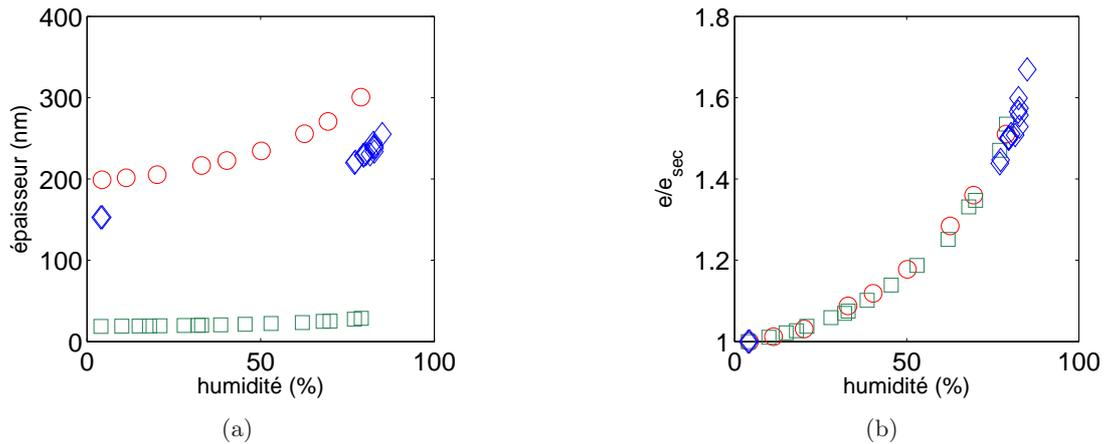
FIGURE 4.4 – (a) Épaisseurs de films de PDMA en fonction de l'humidité relative de l'air - (b) Rapport de l'épaisseur de film de PDMA gonflé sur l'épaisseur sèche.
