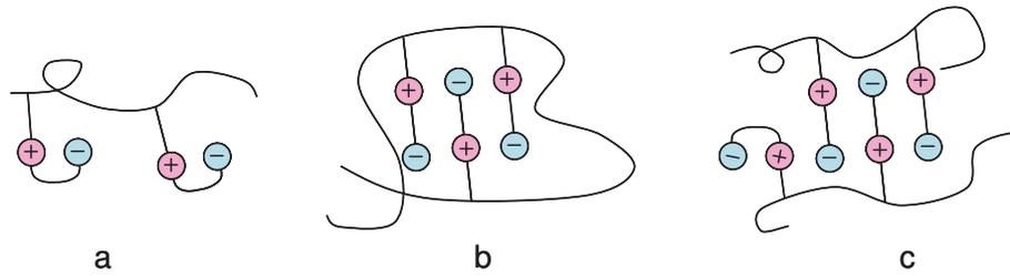
FIGURE 1.14 – Interactions (a) intragroupe, (b) intrachaine et (c) interchaînes entre les charges opposées d'un polyelectrolyte [13].
