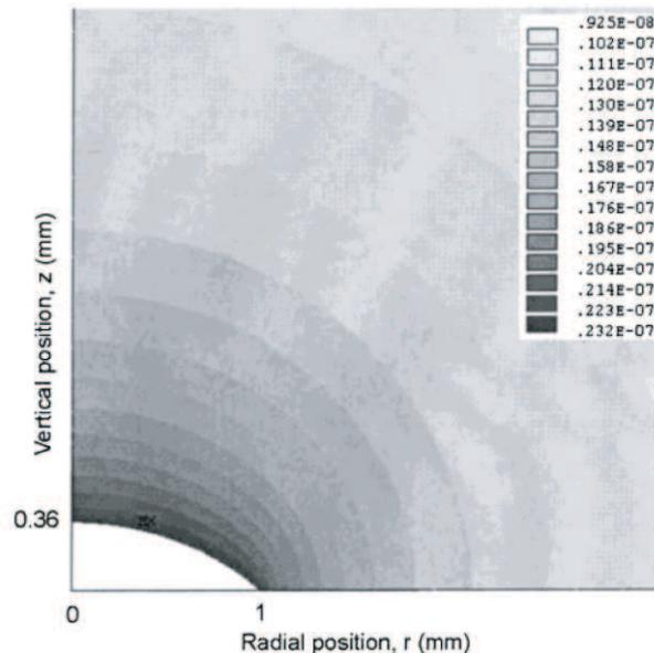
FIGURE 1.25 – Profil de concentration d'eau autour d'une goutte d'eau (en blanc) posée sur un substrat [33]. Les barres grises représentent la concentration d'eau en  $g/mm^3$ .
