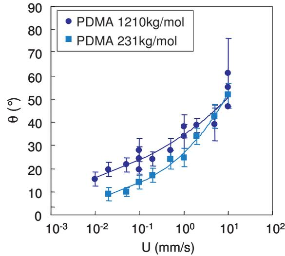
FIGURE 5.10 – Variation de l'angle de contact en fonction de la vitesse de la ligne triple pour des films d'épaisseur  $e = 8 \text{ nm}$  à différentes masses molaires de PDMA.
