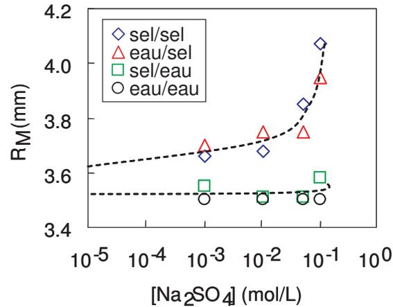
FIGURE 3.20 – Evolution du rayon de la goutte en fonction de la concentration en sel dans la goutte ou la solution de PDADMAC de préparation des films. Les cercles noirs (pas de sel ni dans la goutte, ni dans le film) sont reportés à plusieurs concentration à titre comparatif.
