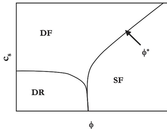
FIGURE 1.12 – Diagramme de phase d'une solution de polyélectrolyte contenant du sel à concentration  $c_s$ . DR est le régime dilué où les chaînes sont rigides, DF et SF sont respectivement les régimes dilué et semi-dilué où les chaînes sont plus flexibles grâce à la présence d'un sel en quantité significative.
