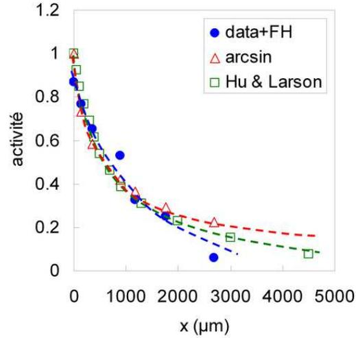
FIGURE 4.6 – Profil d'humidité à l'équilibre avec un film de PDMA sur lequel est posé une goutte d'eau d'environ 1 mm de rayon.  $x$  est la distance par rapport à la ligne triple. (●) Résultats expérimentaux - (△) Modèle en arcsin ( $\theta = 0$ ) - (□) Modèle Hu et al. ( $\theta = 15^\circ$ )
