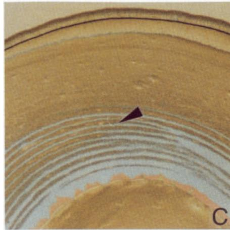
FIGURE 1.31 – Anneaux multiples observés par Adachi *et al.* lors de la reculé de la ligne de contact d'une goutte de suspension colloïdale [40].
