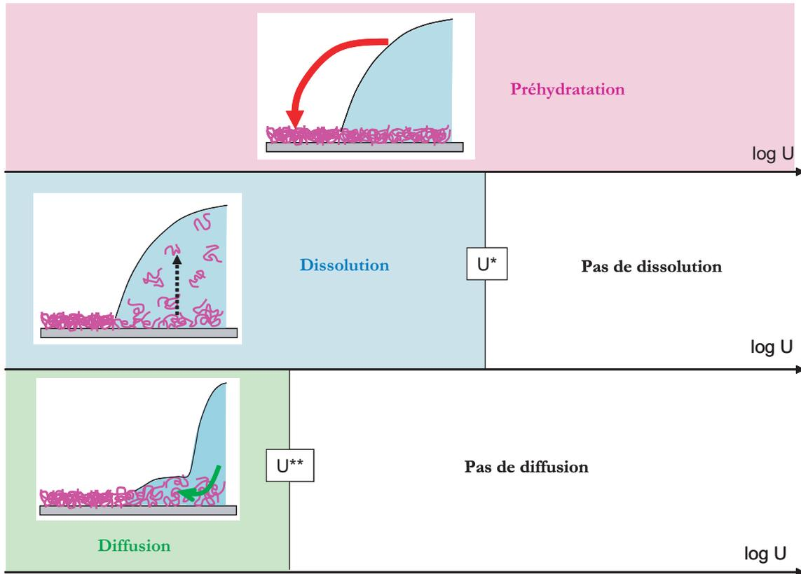
FIGURE 5.4 – Diagramme des différents transferts de masse en fonction de la vitesse de la ligne de contact.
