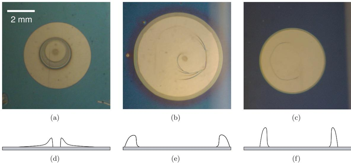
FIGURE 3.32 – Figures de séchage d'une goutte d'eau posée sur un film de (a,d) PDMA (b,e) PDADMAC (c,f) Polyzwitterion (épaisseur sèche  $e \simeq 100 \text{ nm}$ ). Un schéma du profil du dépôt se trouve sous chaque photo. L'échelle est la même pour les trois figures.
