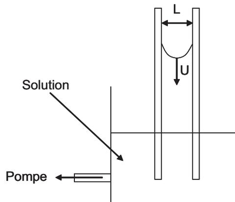
FIGURE 5.23 – Montage d'étude de la reculée de la ligne de contact : deux plaques parallèles de verre sont trempées dans une solution de polymère ou une suspension colloïdale. Par capillarité, le liquide monte entre les deux plaques. Une pompe permet de vider le liquide.
