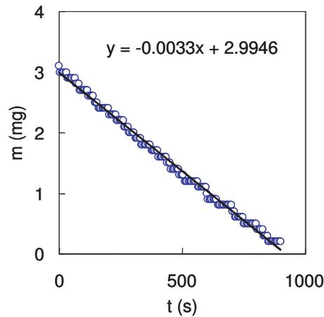
FIGURE 3.24 – Variation de la masse au cours du temps d'une goutte d'eau posée sur un film de polymère neutre avec volume initial de  $3 \mu L$ .
