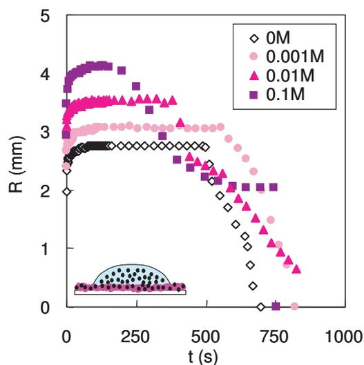
FIGURE 3.29 – Variation du rayon de la goutte au cours du temps pour différentes teneurs en sel pour une épaisseur de film de polyzwitterion de 15 nm.
