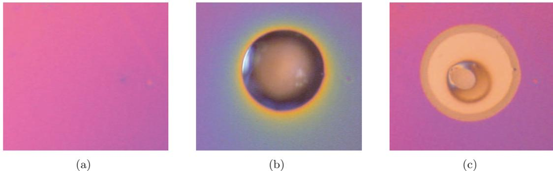
FIGURE 4.1 – Mise en évidence du gradient d'humidité autour d'une goutte d'eau : (a) Avant le dépôt de la goutte - (b) Goutte d'eau posée sur le film de polymère hydrophile - (c) Trace laissée par la goutte d'eau après son évaporation complète.
