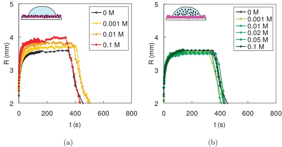
FIGURE 3.19 – Evolution du rayon de la goutte au cours du temps pour différentes concentration de sel dans (a) la solution de préparation du film de PDADMAC et dans (b) la goutte. ( $e \sim 100$  nm)
