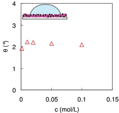
FIGURE 3.25 – Variation de l'angle de décrochage de la ligne de contact en fonction de la concentration en sel dans le film de PDADMAC. Ces angles ont été calculés à partir du rayon de la goutte à chaque instant en supposant que le taux d'évaporation est constant.
