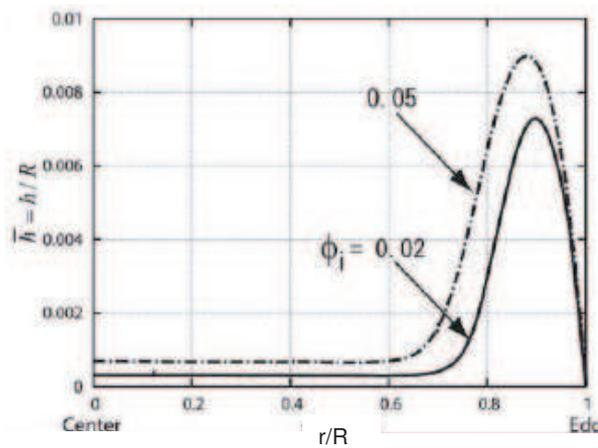
FIGURE 1.34 – Profils de dépôt obtenus expérimentalement après séchage d'une solution polystyrène dans l'anisole [44].
