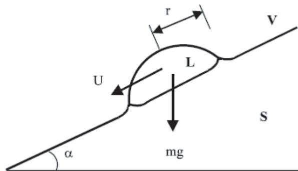
FIGURE 1.23 – La déformation du substrat freine l'avancée de la ligne de contact [30].
