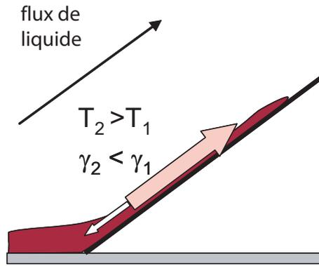
FIGURE 1.28 – Flux de liquide induit par un gradient de tension de surface ou de température.
