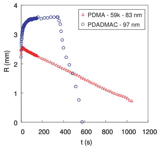
FIGURE 3.18 – Evolution du rayon de la goutte au cours du temps pour le PDMA et le PDADMAC.
