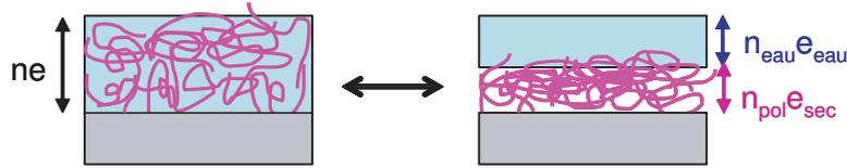
FIGURE 4.5 – Modèle choisi d'une couche gonflée de polymère pour déterminer la fraction d'eau.
