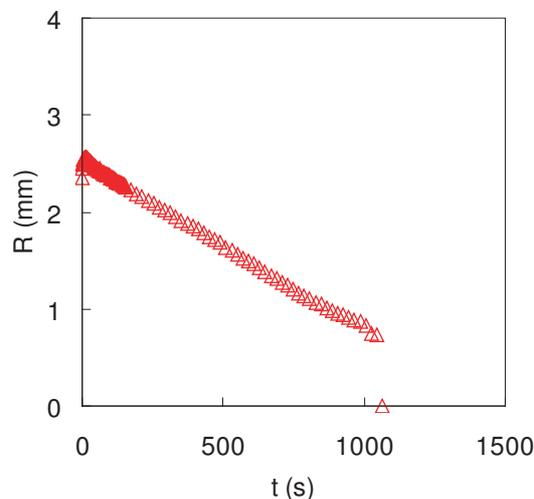
FIGURE 3.11 – Evolution du rayon  $R$  d'une goutte d'eau posée sur une film de PDMA.
