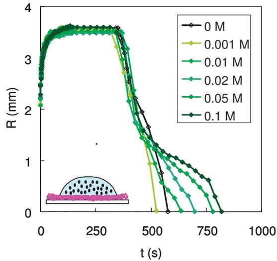
FIGURE 3.22 – Variation du rayon du goutte d'eau salée posée sur un film de PDADMAC pour différentes concentrations en sel dans la goutte.
