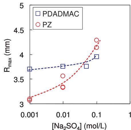
FIGURE 5.21 – Rayon maximal atteint par une goutte d'eau posée sur un film de polyélectrolyte (□) et de polyzwitterion (○) à différentes teneurs en sel.
