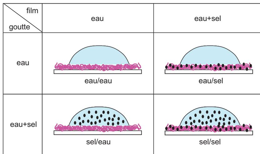
FIGURE 3.15 – Du sel peut être ajouté dans le film ou dans la goutte.
