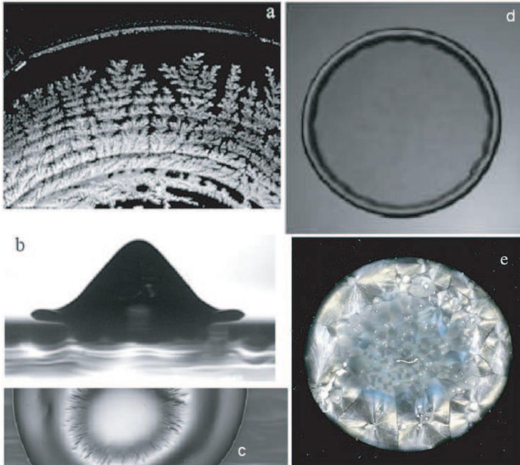
FIGURE 1.35 – Figures de séchage de différents couples (solvant/polymère) : (a) eau/poly(allylammonium) [46] (b) eau/Dextran (vue de profil) [47] (c) anisole/poly(styrène) [48] (d) heptane/poly(diméthylsiloxane) [50] (e) eau/poly(méthacrylate) [45].
