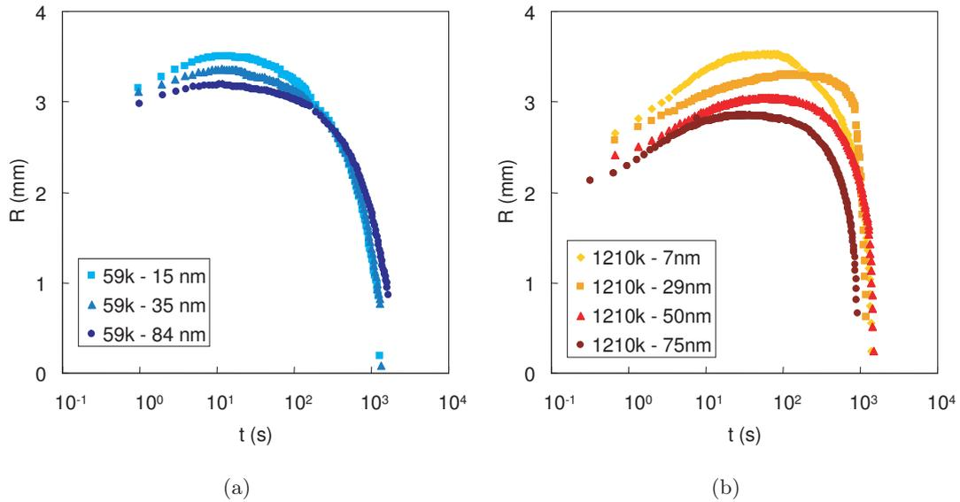
FIGURE 3.6 – Evolution du rayon de la goutte au cours du temps (a) PDMA 59 kg/mol (c) PDMA 1210 kg/mol.
