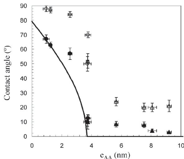
FIGURE 1.21 – Angles d'avancée (symboles blancs) et de reculée (symboles noirs) de l'eau sur des brosses de polymères de différentes épaisseurs. L'hystérèse diminue fortement à partir d'une épaisseur critique de polymère. L'ajustement des résultats expérimentaux à l'aide d'un modèle inspiré de la relation de Young-Dupré permet d'obtenir l'enthalpie libre d'hydratation :  $\Delta G_{PAA}^{hyd} = -1300 \text{ kJ/mol}$ . [24]
