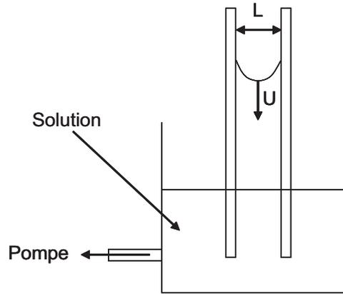
FIGURE E.2 – Montage d'étude de la reculée de la ligne de contact : deux plaques parallèles de verre sont trempées dans une solution de polymère ou une suspension colloïdale. Par capillarité, le liquide monte entre les deux plaques. Une pompe permet de vider le liquide.
