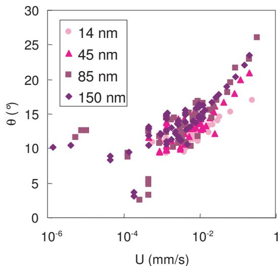
FIGURE 3.28 – Evolution de l'angle de contact en fonction de la vitesse de la ligne triple pour différentes épaisseurs de film de PZ.
