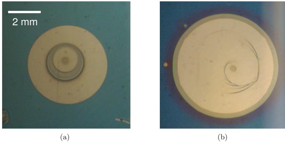
FIGURE 5.24 – *Figures de séchage d'une goutte d'eau posée sur un film de (a) PDMA (b) PDADMAC.*
