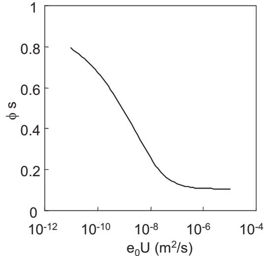
FIGURE 5.8 – Variation théorique (solution numérique) de la fraction d'eau dans le film de polymère gonflé  $\phi_s$  en fonction de la vitesse de la ligne de contact  $U$  multiplié par l'épaisseur initiale  $e_0$  du film de polymère.
