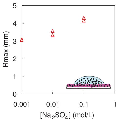
FIGURE 3.30 – Evolution du rayon maximal de la goutte en fonction de la concentration en sel dans la solution de préparation d'un film de polyzwitterion ( $e \simeq 15$  nm).
