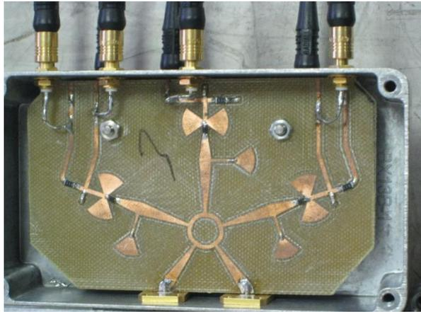
Figure 20. *Démodulateur cinq-port complet réalisé*
