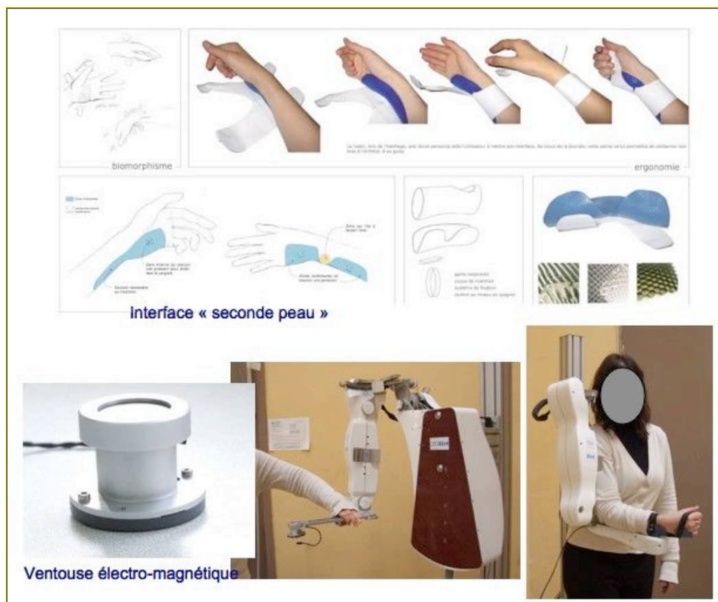
Figure 158. Schémas et essais de matériaux pour la partie « seconde peau » et photos de l'interface de fixation (ventouse électro-magnétique) de la seconde peau au bras exosquelettique
