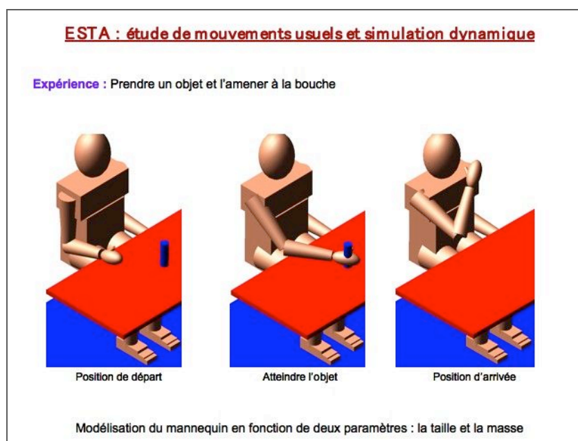
Figure 155. Exemple de simulation dynamique des mouvements pour l'activité : prendre un objet et l'amener à la bouche.
