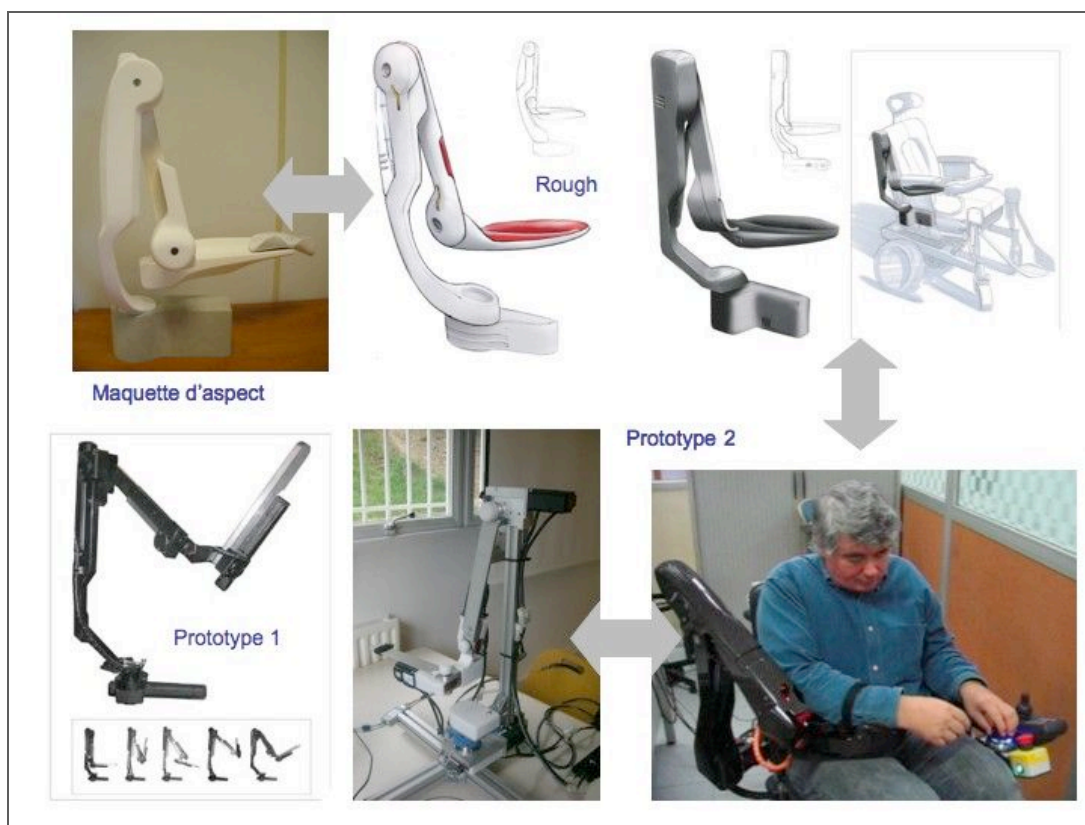
Figure 156. Evolution des représentations intermédiaires du produit: les concepts d'exosquelettes (affirmé et intégré) et la maquette d'aspect du concept affirmé (en haut), le prototype fonctionnel 1 (en bas à gauche) et le prototype 2 design intégré (en bas à droite)
