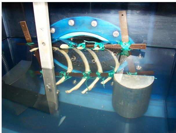
FIGURE 5.2 – Montage expérimental : côtes humaines placées en face de la sonde thérapeutique.
