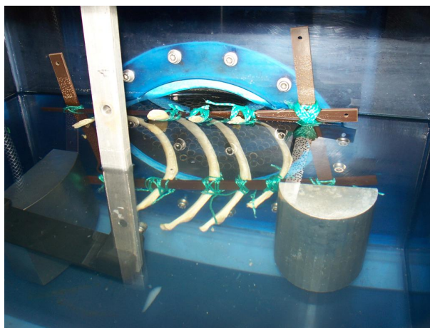
FIGURE 5.2 – Montage expérimental : côtes humaines placées en face de la sonde thérapeutique.
