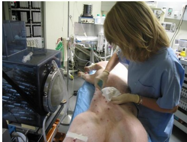
FIGURE 4.12 – Expérience in-vivo : sur la gauche, le réseau de thérapie avec son système de couplage. Sur la droite, l'animal est préparé, du gel échographique lui est appliqué sur l'abdomen pour assurer une meilleure transmission des ultrasons.
