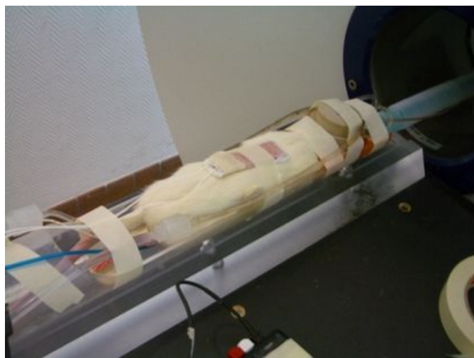
FIGURE 3.16 – Figure de gauche : Photographie du dispositif expérimental. Le transducteur piézoélectrique est placé sur la tête rasée du rat sous anesthésie gazeuse. Figure de droite : Superposition des points de température mesurés par IRM et de la courbe
