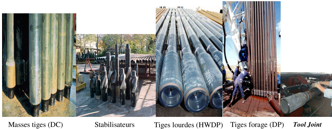
Figure 1.2 : Quelques éléments de la garniture de forage
