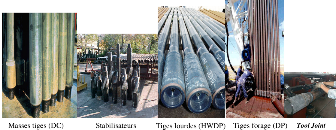
Figure 1.2 : Quelques éléments de la garniture de forage
