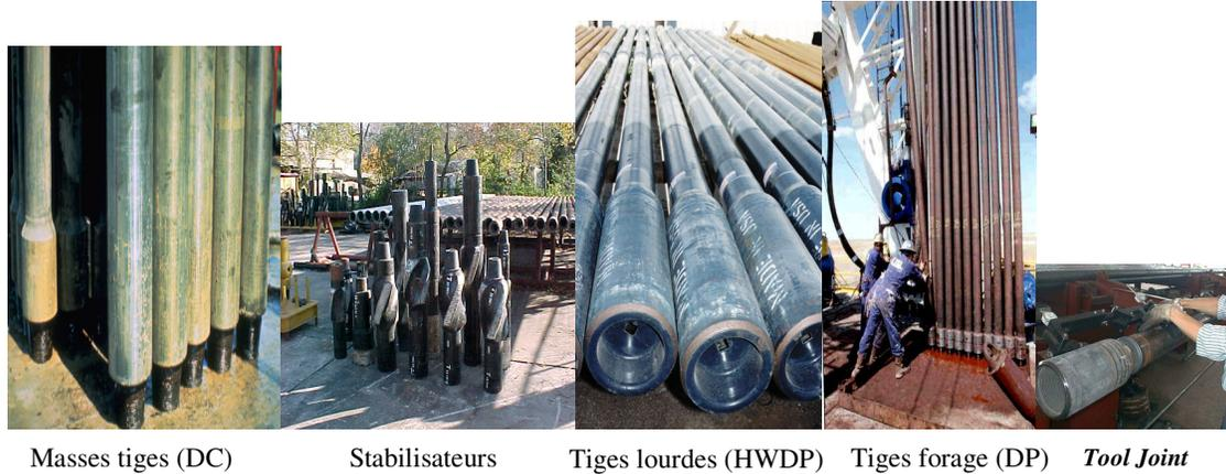
Figure 1.2 : Quelques éléments de la garniture de forage
