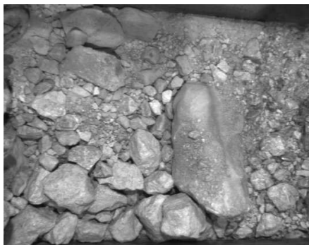
Fig. 2.14: Présence de fines regroupées et déposées sur gros fragments
