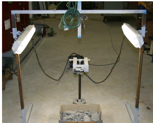
Fig. 5.21: Dispositif expérimental d'éclairage avec incidence variable
