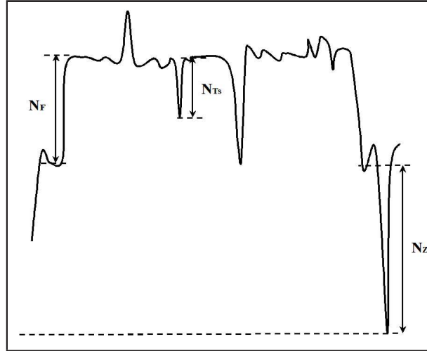
Fig. 2.51: “Niveau de gris relatif” des zones d'ombre plus grand que celui des fragments ( N_z > N_F )
