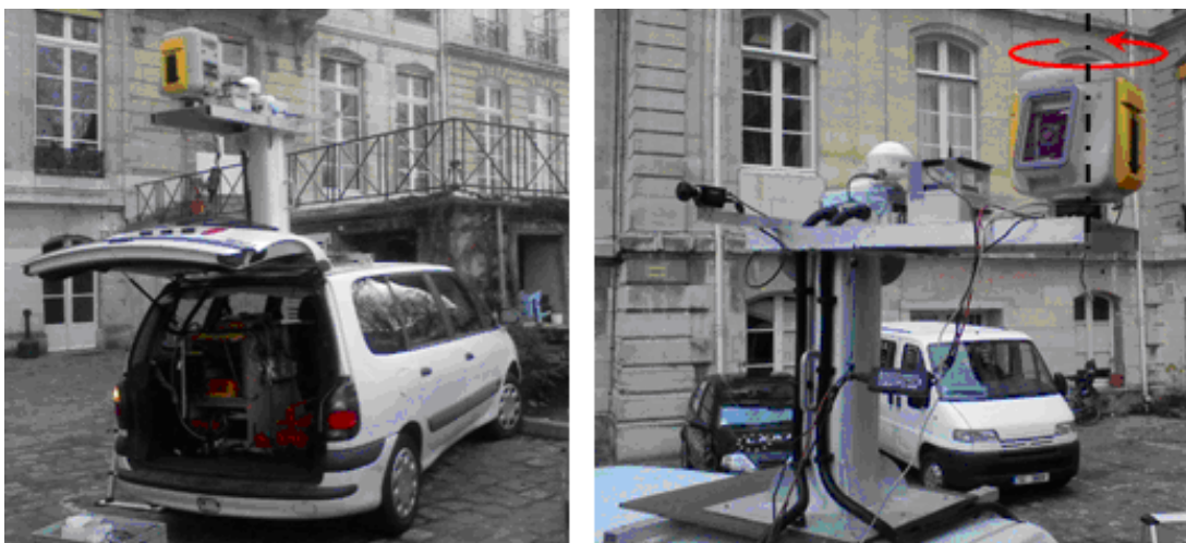
Figure 4-8 : Trimble GX sur LARA-3D
