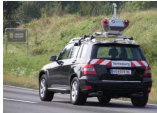
Figure 2-45 : VMX-250, système de Riegl
