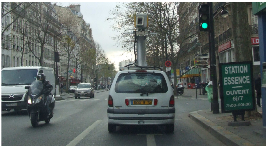
Figure 4-5 : Trimble GX avec accéléromètre sur LARA-3D.
