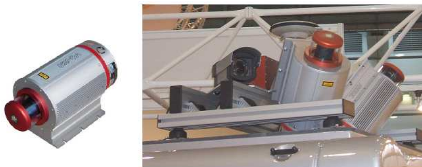
Figure 2-44 : VQ-250, scanner de Riegl
