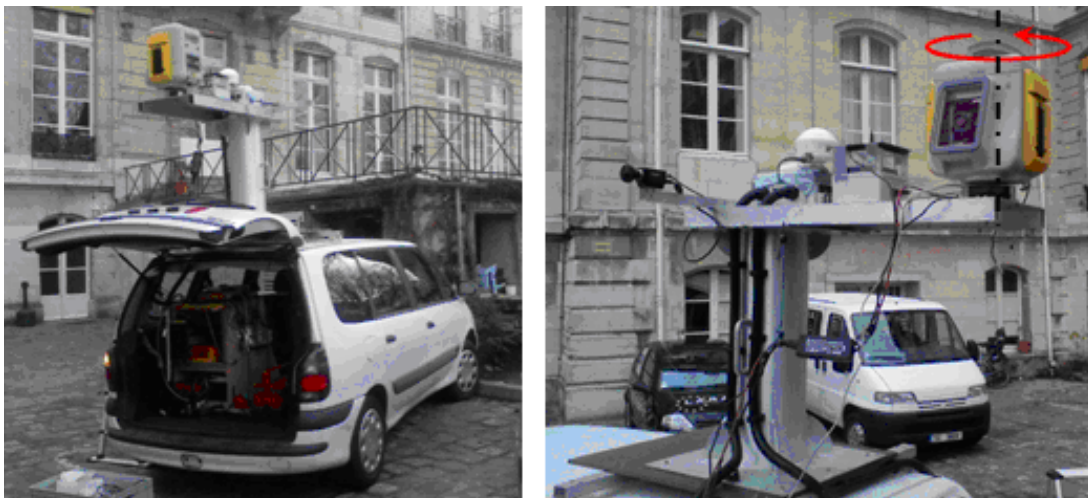
Figure 4-8 : Trimble GX sur LARA-3D
