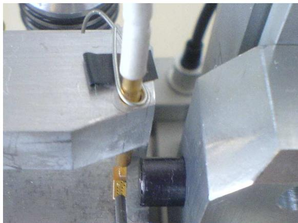
**Figure III.2 Photographie d'EML sous pointes avec un accès seul de courant statique sur le laser.**
