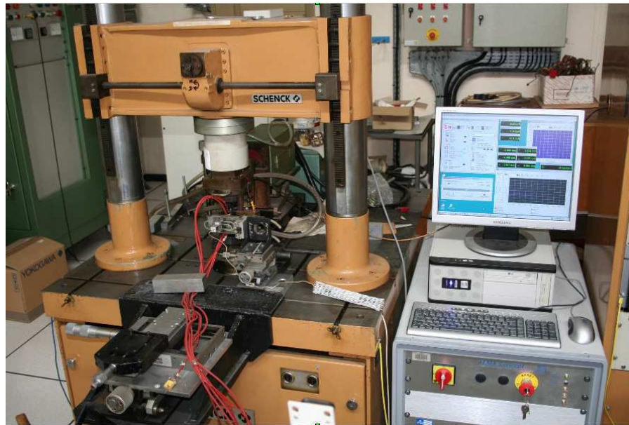
(a) Vue générale du dispositif expérimental montrant la machine d'essai et le système de pilotage et d'acquisition.
