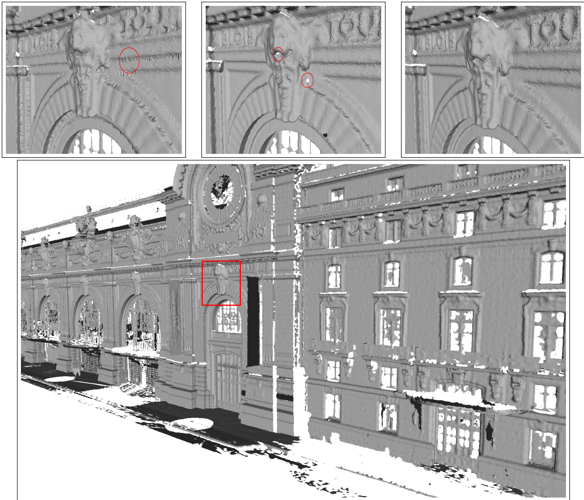
FIGURE 4.32 – Maillage du nuage de points FX_GX_Orsay avec en haut un gros plan sur le maillage de différentes méthodes (à gauche BPA, au milieu GOPI et à droite notre méthode de triangulation) et en bas une vue large du modèle triangulé par notre méthode.
