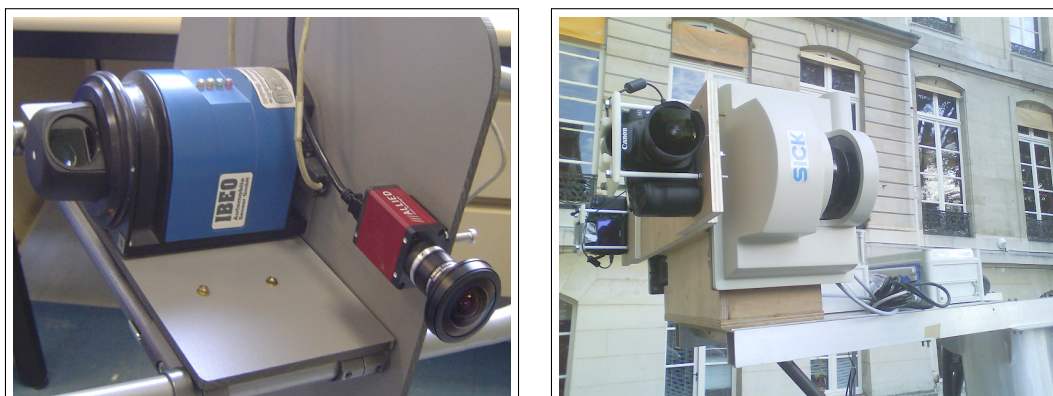
FIGURE 5.1 – A gauche plateforme de la version 2007 de LARA3D avec une caméra Marlin d'AVT et un scanner IBEO LD. A droite la plateforme de la version 2010 avec un appareil photo Canon EOS 5D et un scanner SICK LMS 221.
