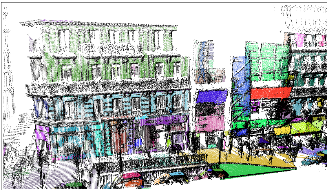
FIGURE 4.11 – Segmentation du nuage de points Stereopolis_Soufflot avec les plans dans des couleurs aléatoires et les points non classés en noir.
