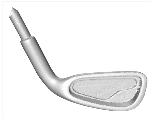
FIGURE 1.16 – Triangulation d'un nuage de points avec l'algorithme « Cocone » (source [Amenta et al., 2002]).
