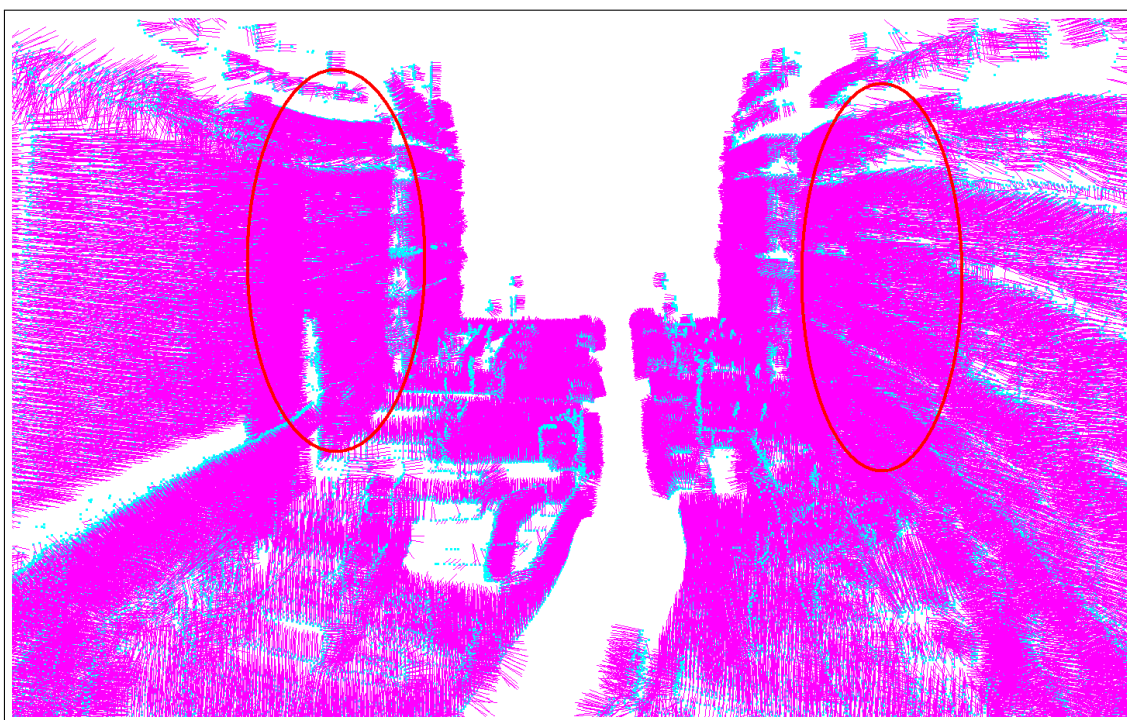
FIGURE 2.13 – Calcul des normales en utilisant la direction des lasers pour le nuage LARA3Dv2007_Soufflot (en bleu les points et en rose les normales).
