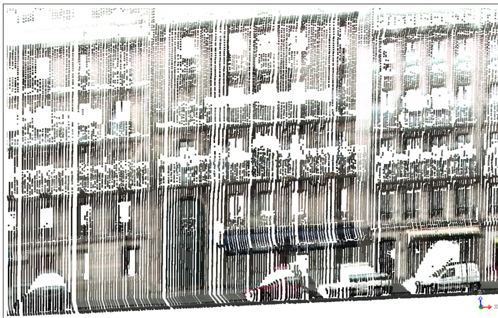
FIGURE 5.8 – Nuage de points de la rue Gay-Lussac à Paris coloré avec une caméra basse résolution Marlin par couplage direct.
