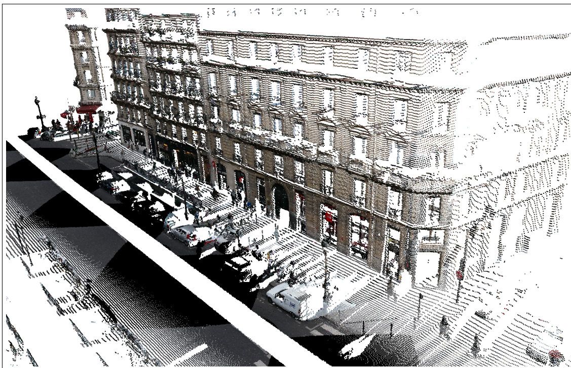
FIGURE 5.10 – Nuage de points coloré de la rue Soufflot à Paris, utilisation de l'appareil photo Canon par mise en correspondance de données image et laser.
