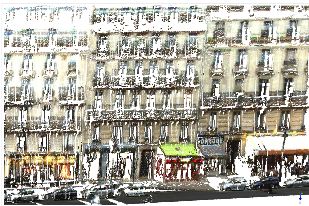
FIGURE 5.9 – Nuage de points coloré de la rue Soufflot à Paris, utilisation de la caméra moyenne résolution Pike par mise en correspondance de données image et laser.
