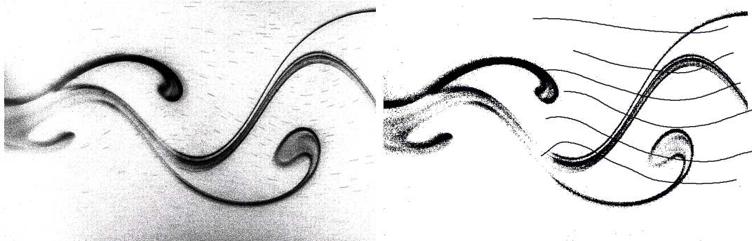
FIG. 3.7: Illustration de la différence entre lignes de courant et lignes d'émission dans le cas de l'allée de Bénard-von Karman derrière un cylindre.
