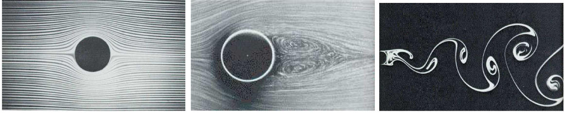
FIG. 2.1: Visualisation des différents régimes d'écoulement derrière un cylindre (Van Dyke (1982)).
