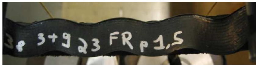
FIG. 2.8: Flambement dans le plan en flexion/compression
