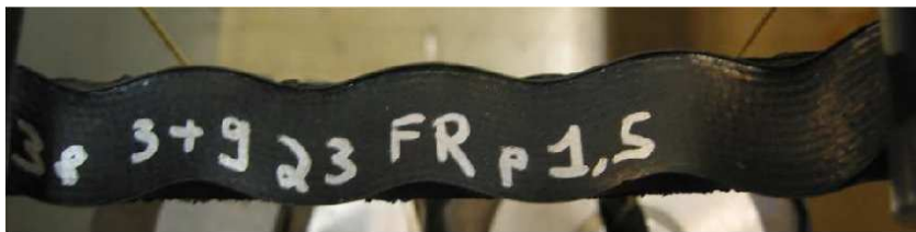
FIG. 10.16: Flambement sous flexion circulaire observé expérimentalement (d'après (Caillard, Michelin)).
