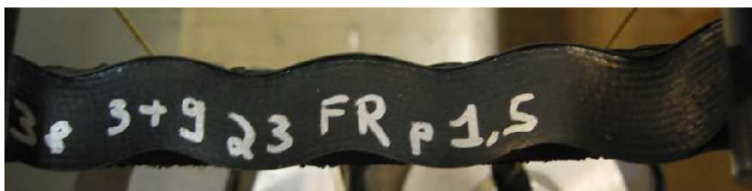
FIG. 1.9: Flambement de la nappe sous flexion circulaire (d'après (Caillard, Michelin))
