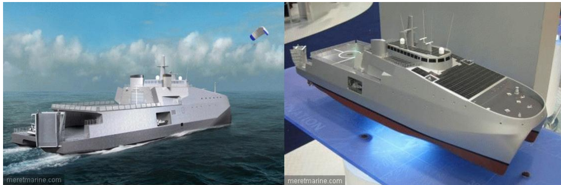
Figure 2-37. ECOSHIP : un projet de navire éco-conçu : une coque en aluminium, une voile type kite surf, des panneaux solaires,... (Image mer et marine)
