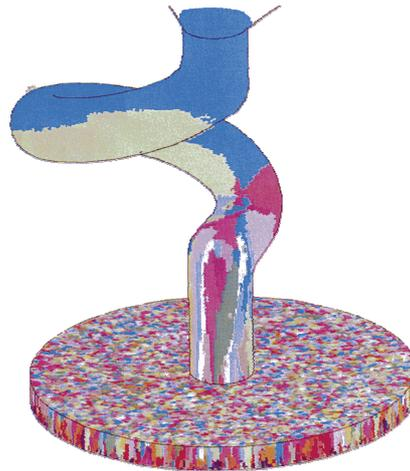
Figure.I.3.Sélecteur d'orientation cristalline [DUR 97]
