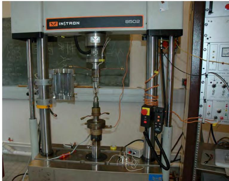
Figure.II.10.Machine INSTRON 8502 utilisée pour les essais de fatigue
