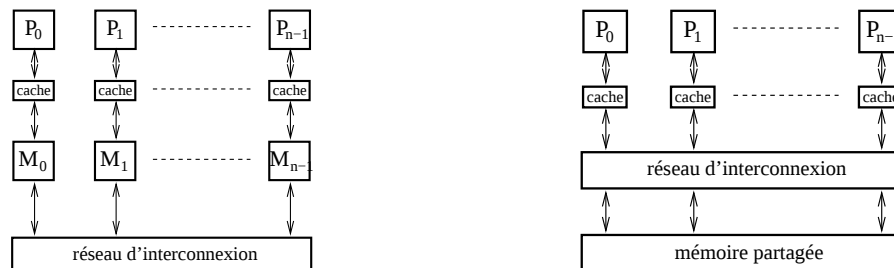
FIG. 6.1 – Mémoires distribuée et partagée (P : processeur, M : mémoire)
