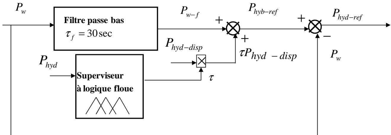
Figure 4.5 Structure du superviseur n°2
