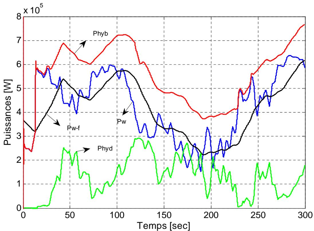
Figure 4.10 Allure des puissances actives de différentes sources
