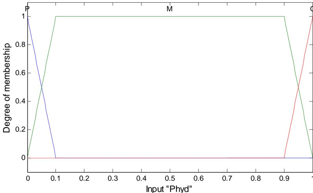
Figure 4.7 Fonction d'appartenance de grandeur d'entrée  $P_{hyd}$
