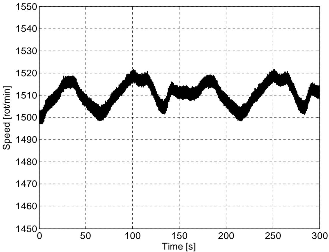
Figure 3.34 Vitesse de rotation du générateur éolien
