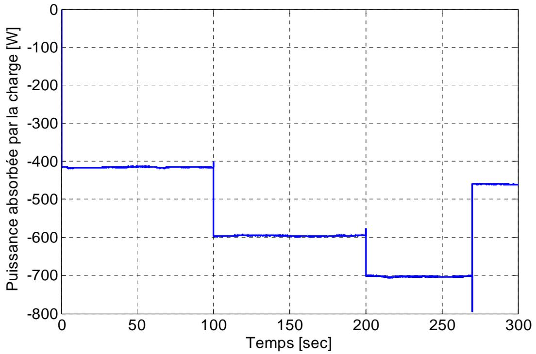
Figure 3.13 Puissance active absorbée par le site isolé
