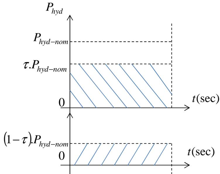
Figure 4.2b Principe de commande de la puissance hydraulique
