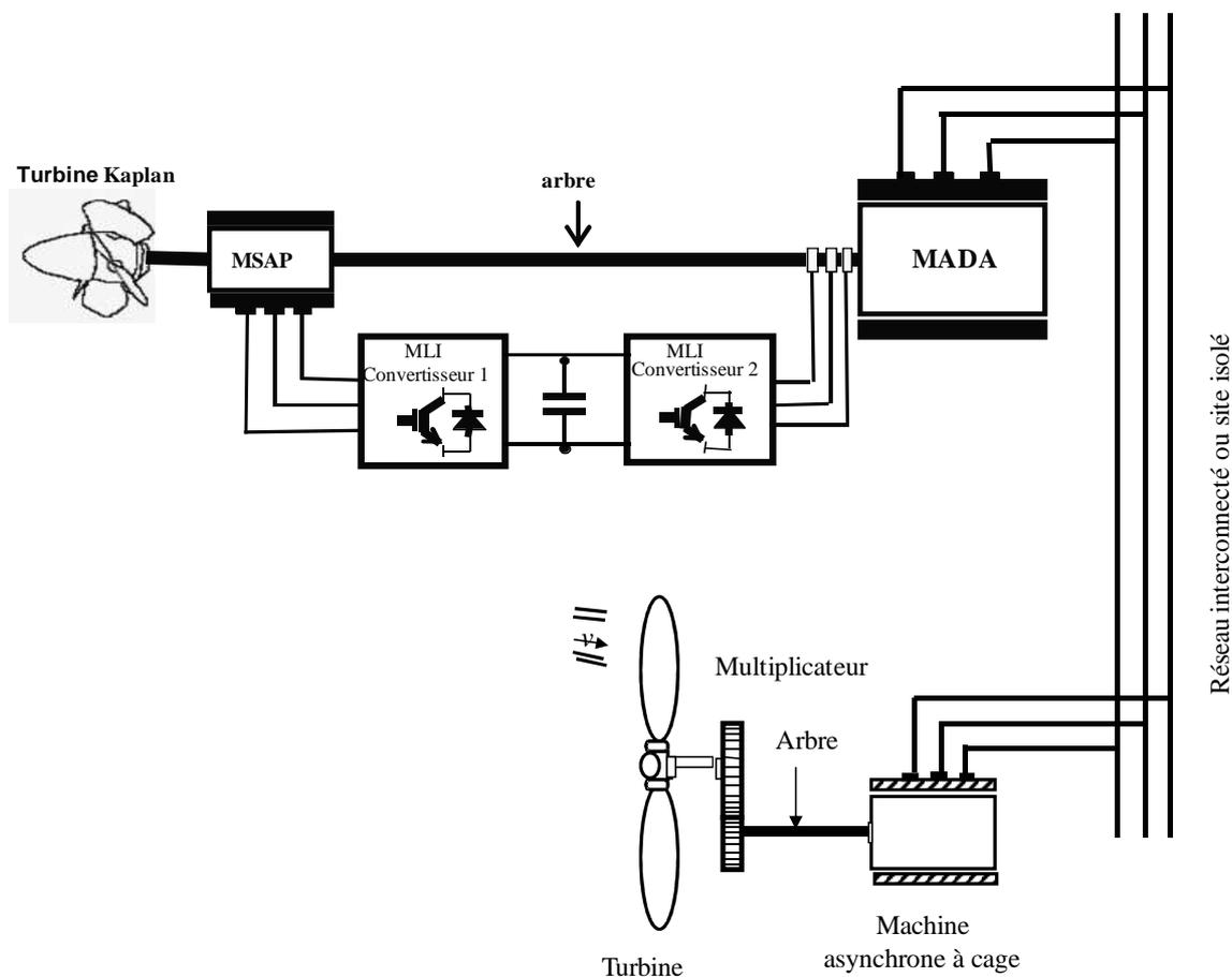
Figure 3.4 Schéma de principe du Système hybride
