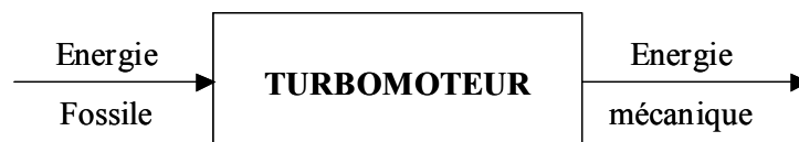
Figure 1 : Flux fonctionnel d'un turbomoteur.
