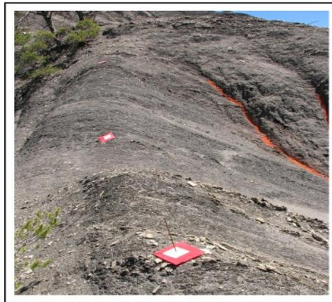
**Figure III.8 - Deux mires sur la crête d'une ravine (plaques plastifiées carrées de taille différente et superposées, rouges et blanches).**
