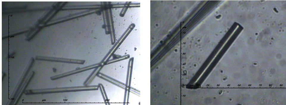
Figure 20 : Observation des diamètres et longueurs des fibres par microscope optique après la pyrolyse
