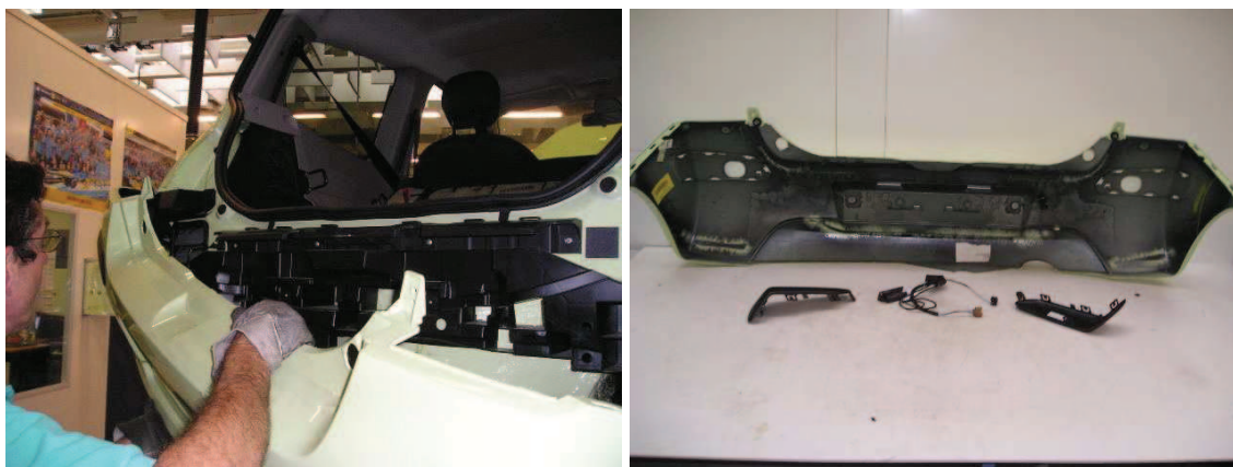
Figure 22 : Opération de démontage et exemples de pièces pouvant être extraites (Bouclier arrière, Source RENAULT)
