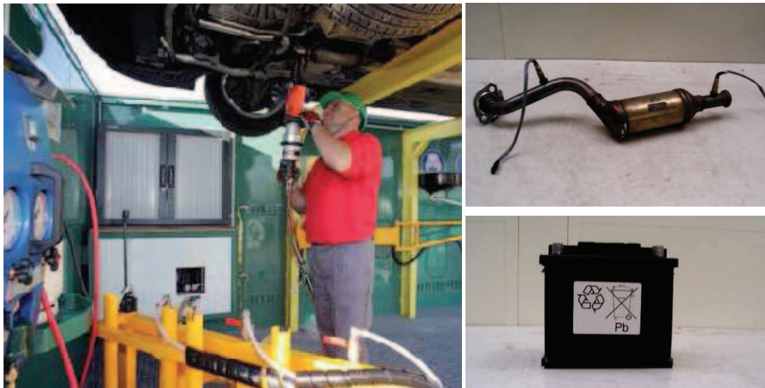
Figure 21 : Unité de dépollution mobile (Source Re-Source Industries) et pièces pouvant être extraites lors de la phase de dépollution (Pot catalytique et batterie de démarrage, Source RENAULT)
