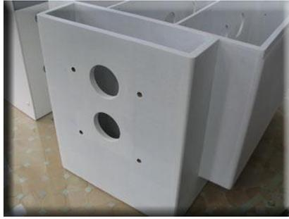
Figure.I.17. Exemple d'une pièce MDF poncée avec un papier de verre P240 puis revêtue avec une couche de primer blanc.
