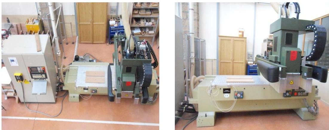
Figure.II.22. Défonceuse 3 axes à commande numérique.
