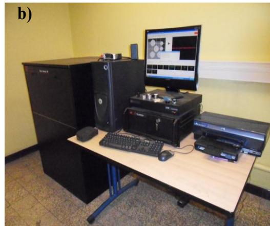
Figure.II.14 : a) Nanoduromètre NHT, b) Nanoduromètre XP MTS.
