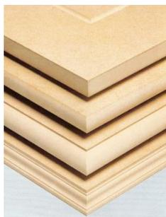
Figure.I.14. Exemples de sciage des panneaux de MDF.
