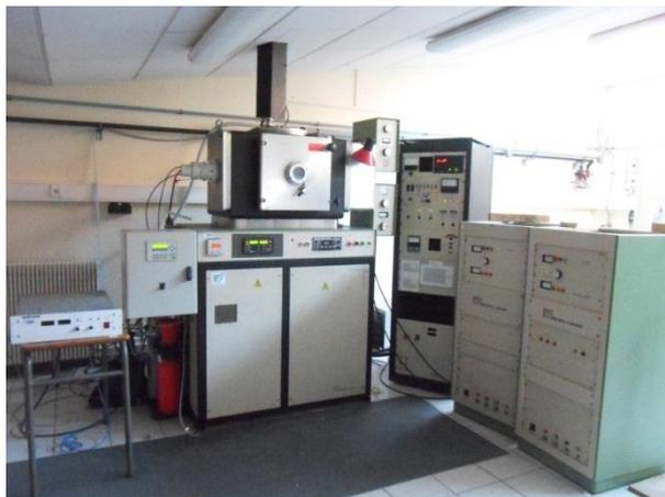
Figure.II.3. Bâti de pulvérisation magnétron NORDIKO 3500.
