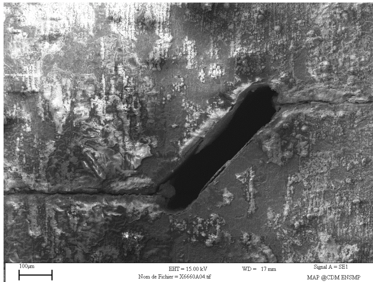
Figure 3.2-4 : Amorçage et propagation de fissure sur une entaille à 45° X6660A ( \Delta\epsilon=0.5\% f=0.05\text{Hz} T = 950^\circ\text{C} )
