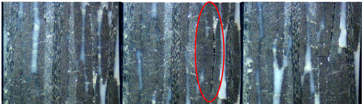
(e) Palier à 90% de la contrainte à rupture moyenne (soit environ 474MPa)
