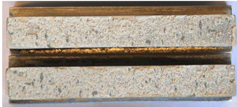
Figure V.8 – Clichés des faciès à rupture de type cohésif d'une éprouvette de colle polyuréthane sollicitée avec un angle de 30^\circ : l'adhésif (de couleur gris clair) est présent des deux côtés du substrat métallique (ici un alliage d'aluminium)
