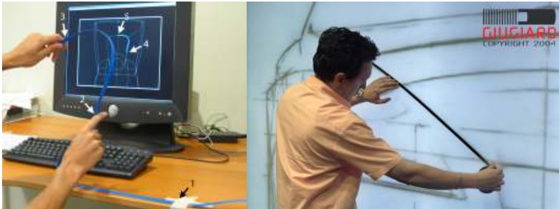
Figure 33 : Dispositif matériel de la méthode « ShapeTape » (Grossman, Balakrishnan, et Singh 2003) Illustration du Taping utilisé pour le design automobile (Barone 2004)
