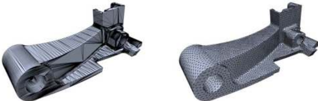
Figure 44 : Exemple de maillage d'une pièce mécanique à droite (Botsch et al. 2006)
