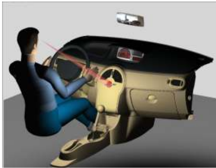
Figure C 3 : Cône de visualisation du bouton warning utilisé pour la détection de collision
