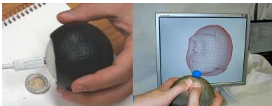
Figure 32 : Accessoires de déformation : à gauche : Tango (Pai et al. 2005) à droite : Digital Foam (Smith, Thomas, et Piekarski 2008)
